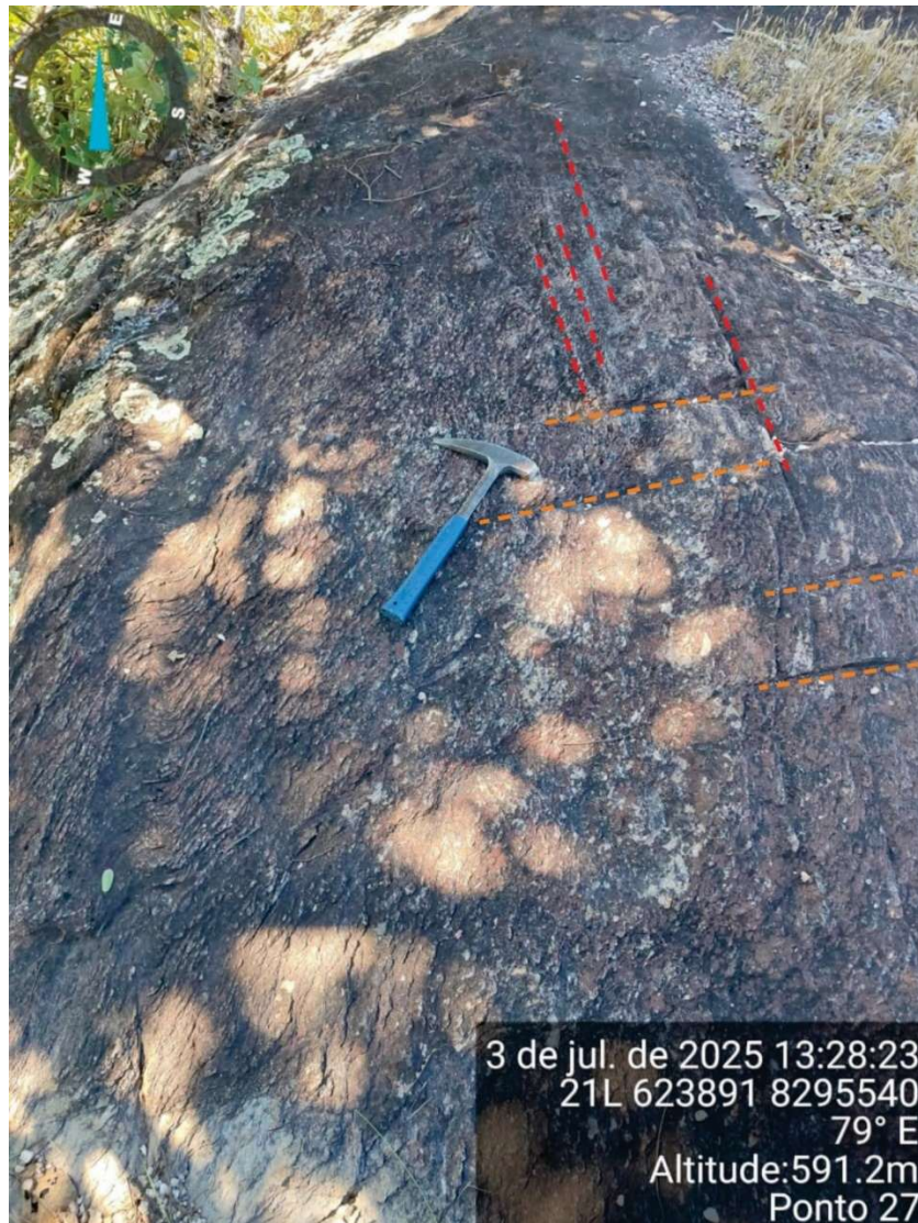
Figura 41- Afloramento de filito do Grupo Cuiabá, tracejado vermelho indicam direção da foliação com caimento para NW e o tracejado alaranjado indicam fraturas subverticais e perpendiculares ao ângulo de foliação.
