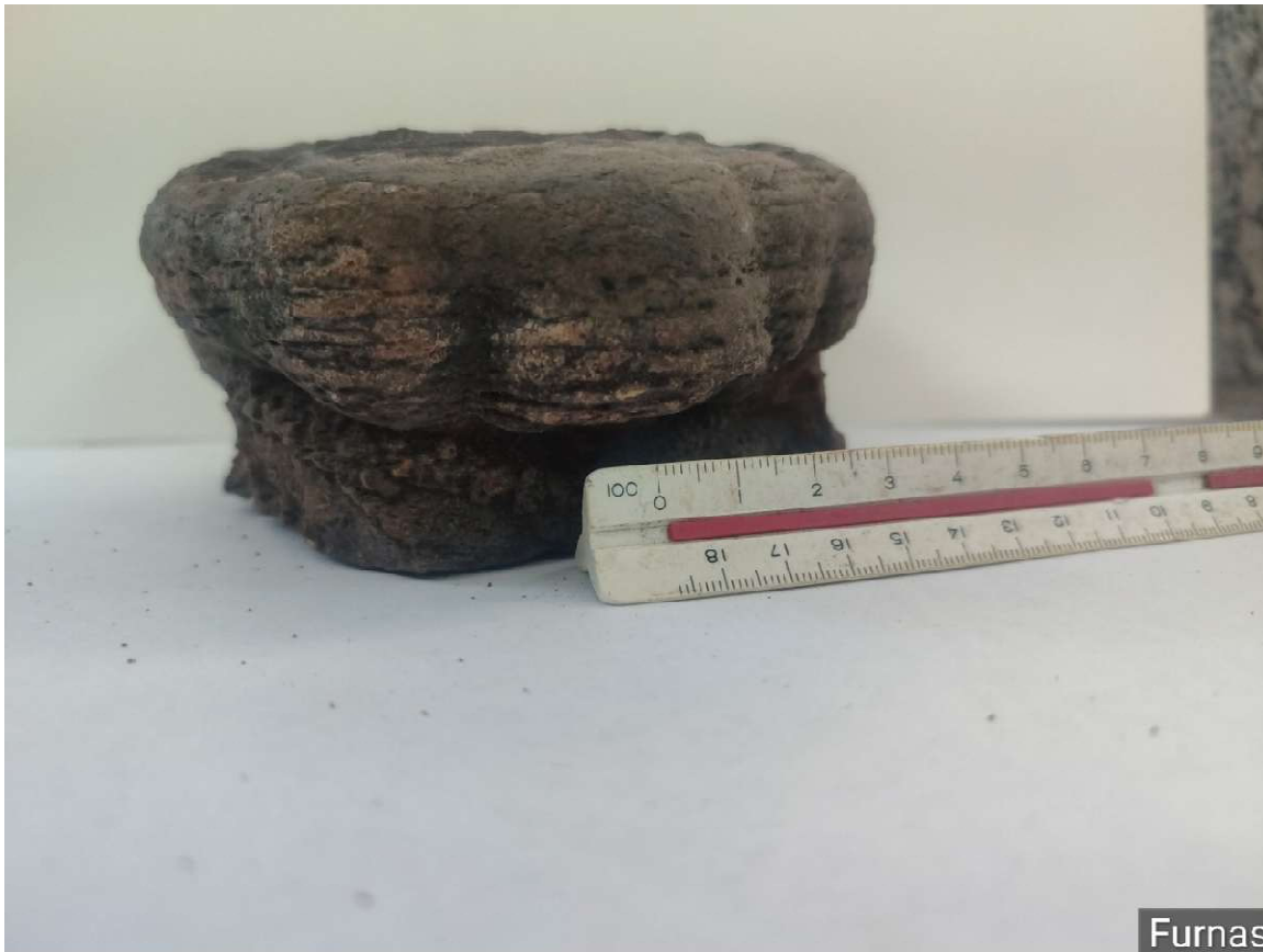
Figura 22 - Concreção ferruginosa do ponto 14 com estratificação plano paralela no início do processo de lateritização, Fonte: Acervo pessoal dos autores.
