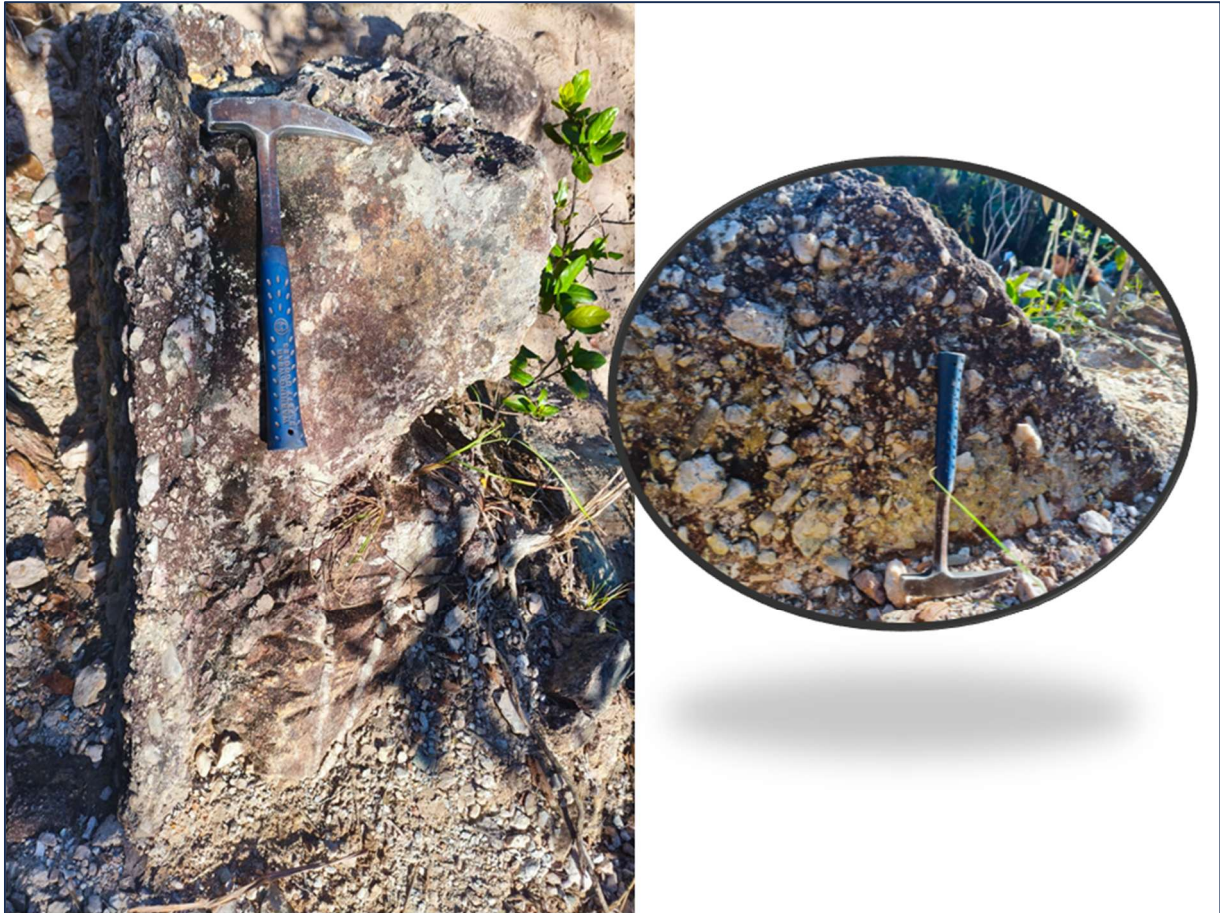
Figura 15 - Metabrecha com clastos angulosos e centimétricos, provavelmente transportada por uma corrente de turbidez. Fonte: Acervo pessoal dos autores.
