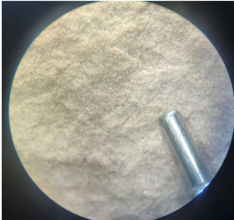
Figura 30- Amostra do ponto 48 da Formação Aquidauana visto em lupa de bancada evidenciando grãos brilhosos. Fonte: Acervo pessoal dos autores.
