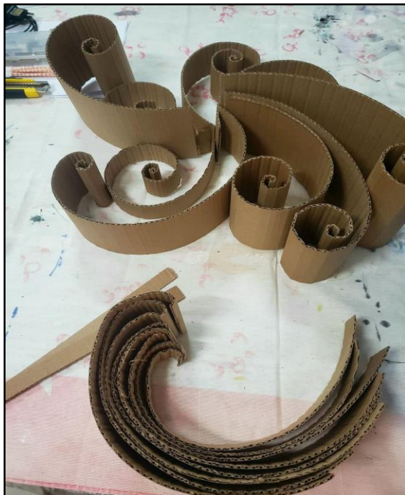
Figura 47 - Tiras de papelão retorcidas após o processo de “quebra” do miolo.
