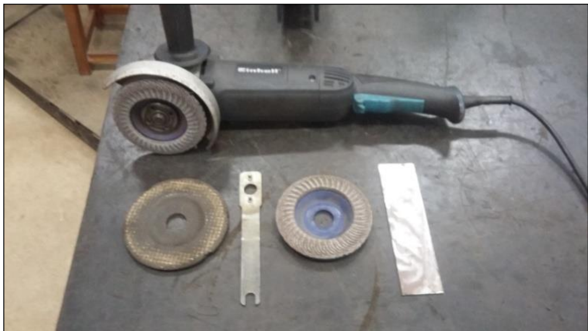
Figura 11 - Lixadeira, discos e corpo de prova limpo.
