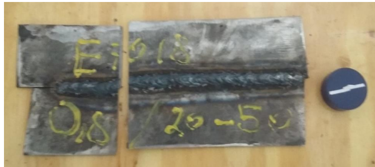
Figura 17 - Cordão de solda confeccionado com corrente de 55 A e abertura de raiz de 0,75 mm
