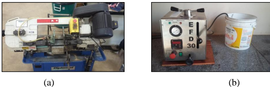
Figura 13 - Serra fita(a), Embutidora (b)
