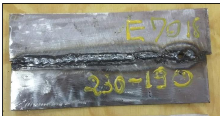
Figura 16 - Chapa soldada com corrente de 90 A.
