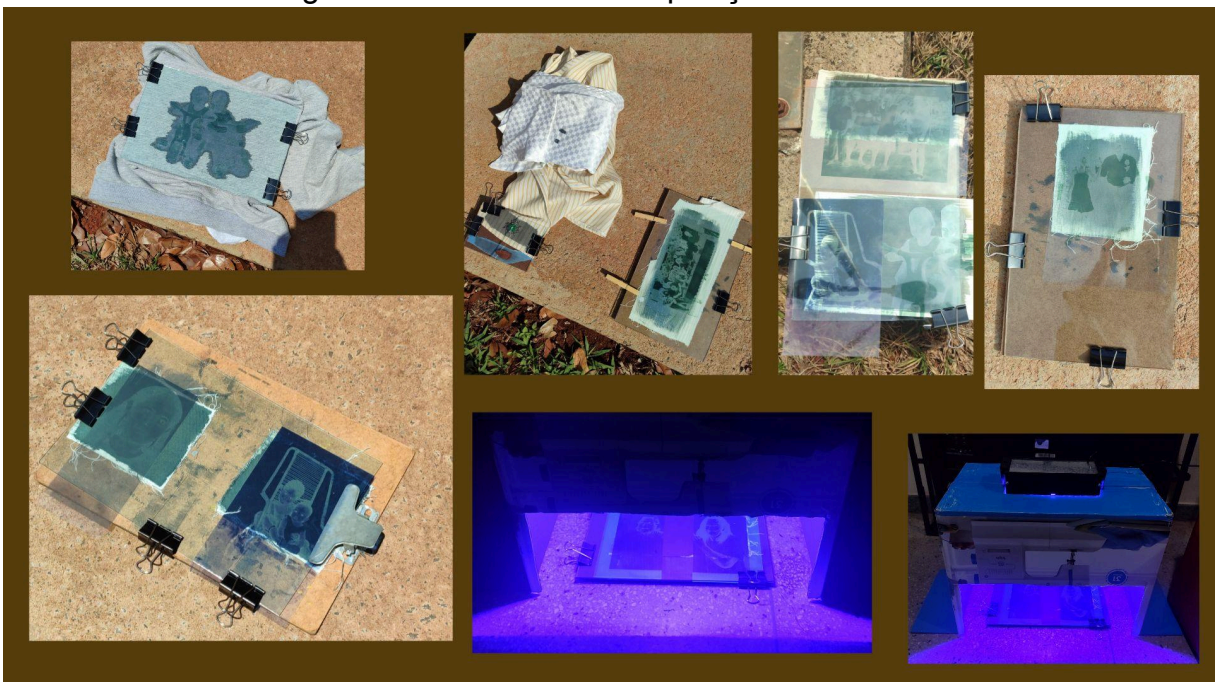
Figura 12 – Processo de exposição em luz UV
