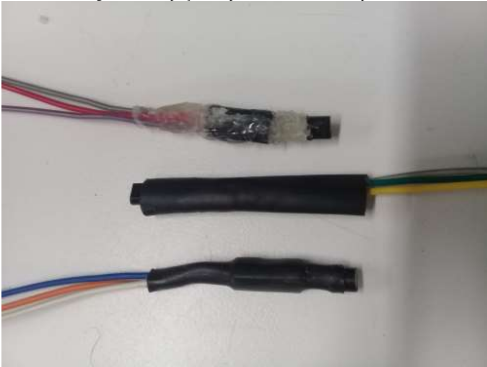
Figura 33 – Adaptação completa dos sensores de temperatura
