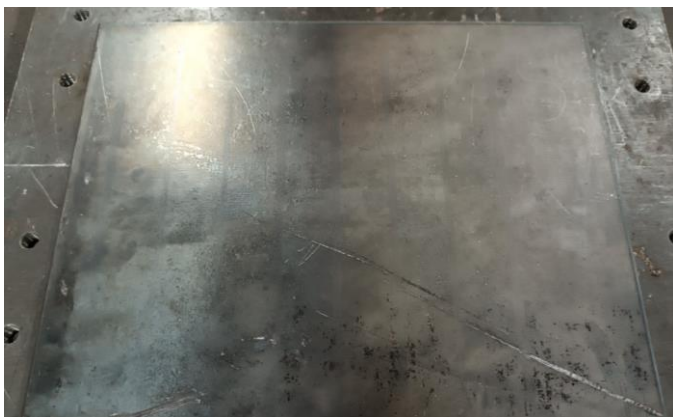
Fig. 12. Chapa de aço na condição como recebida totalmente coberta por carepa. Fonte: Elaboração própria.
