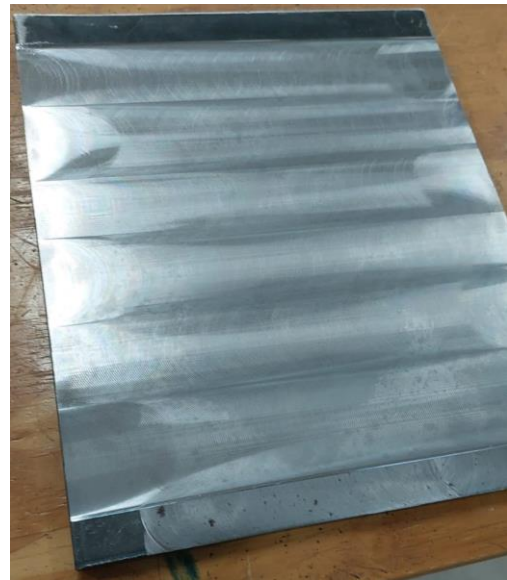
Fig. 13. Chapa de aço após processo de fresamento. Fonte: Elaboração própria.
