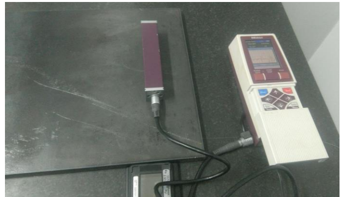
Fig. 16. Fotografia exemplificando como foram realizadas as medições de rugosidade com o instrumento. Fonte: Elaboração própria.
