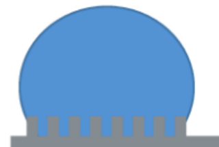
Fig. 3. Ilustração de uma gota sobre uma superfície rugosa no modelo de Wenzel. Fonte: (ZANCAN, 2017).
