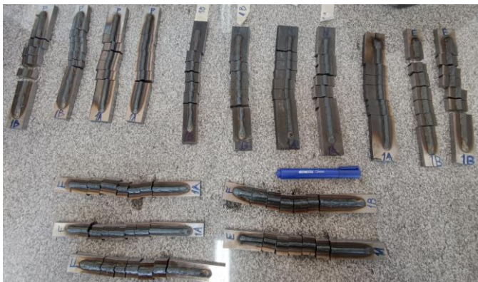
Fig. 23. Cortes realizados em cada um dos 16 cordões em 6 posições diferentes. Fonte: Elaboração própria.
