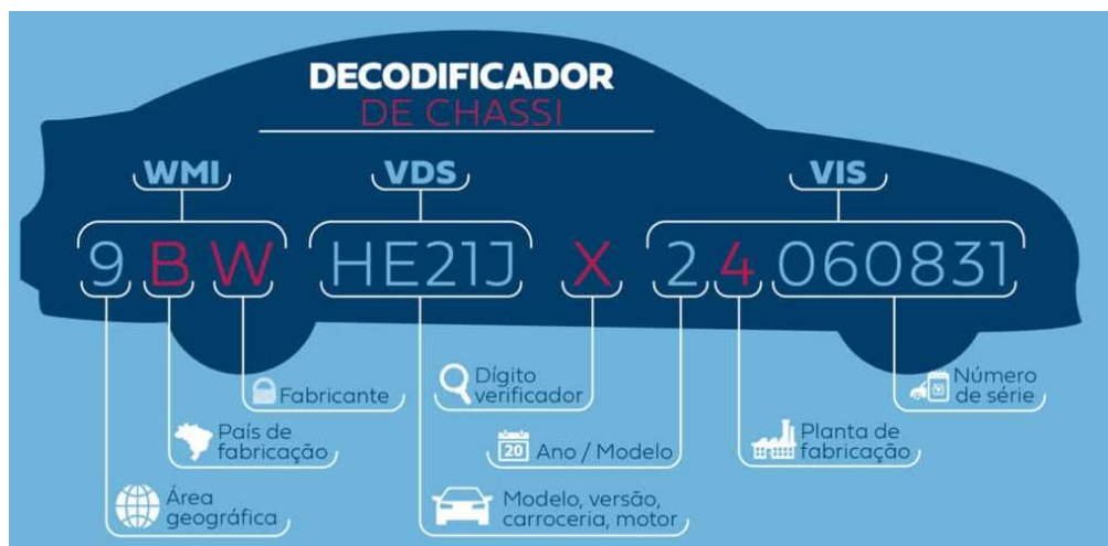
Figura 13 - Decodificação do Código VIN
