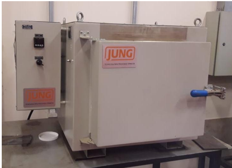
Figura 3.6: Forno de tratamento térmico utilizado para pré-aquecimento das placas de teste
