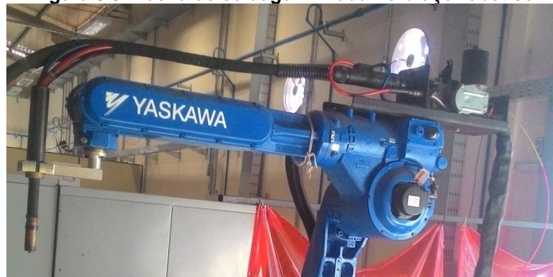
Figura 3.5: Tocha de soldagem fixada no braço robótico
