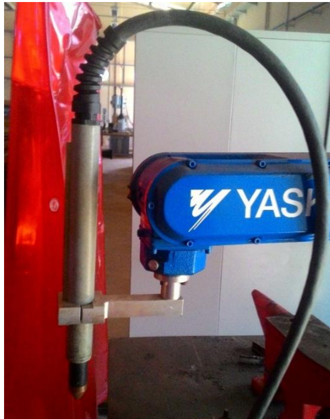
Figura 3.1: Tocha de corte a plasma fixada no braço robótico Yaskawa®
