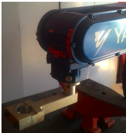
Figura 3.14: Peça fabricada para fixação das tochas no braço robótico
