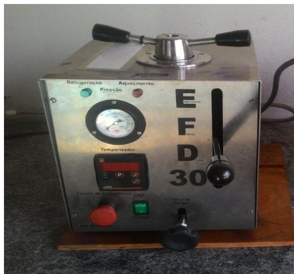
Figura 3.10: Embutidora de amostras Fortel EFD30
