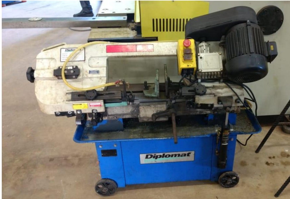
Figura 3.8: Serra fita utilizada
