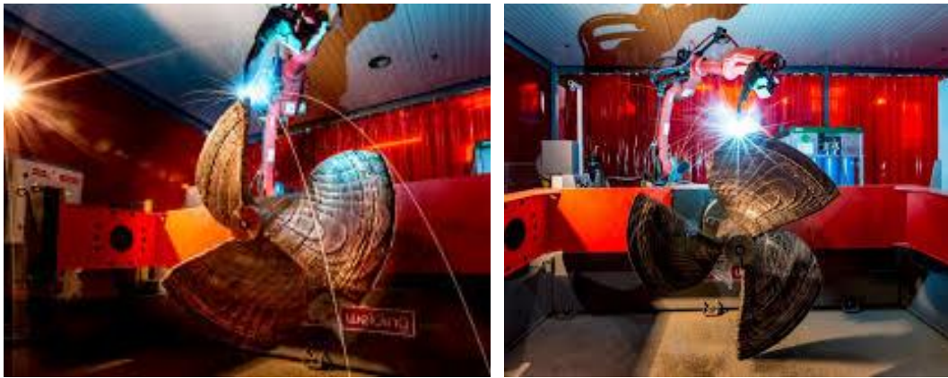
Figura 3 (a) e Figura 3 (b) – Propulsor marítimo fabricado por meio de MADA, usando ligas de níquel-alumínio-bronze
