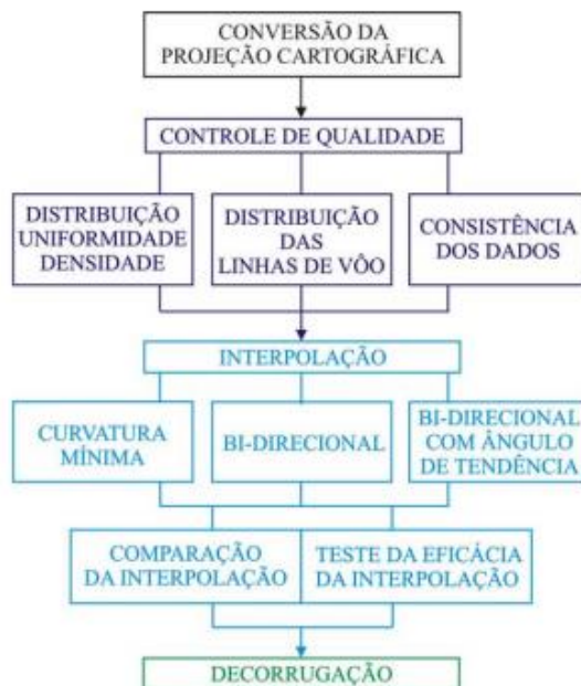
Figura 3: Fluxograma das etapas do processamento dos dados magnéticos. (Retirado de Leão-Santos, 2006).
