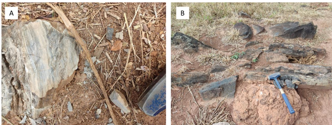
Figura 66: A) Metachert ponto 22TF01_096 e B) Blocos de metachert já alterados, ponto 22TF01_100.
