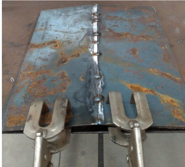
Figura 26 – Preparação de soldagem
