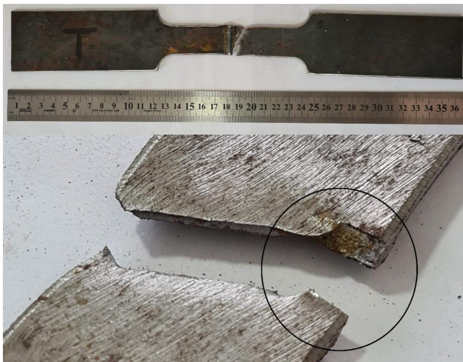
Figura 40 – CP2 para o CO2 puro rompido e rompimento na região de solda
