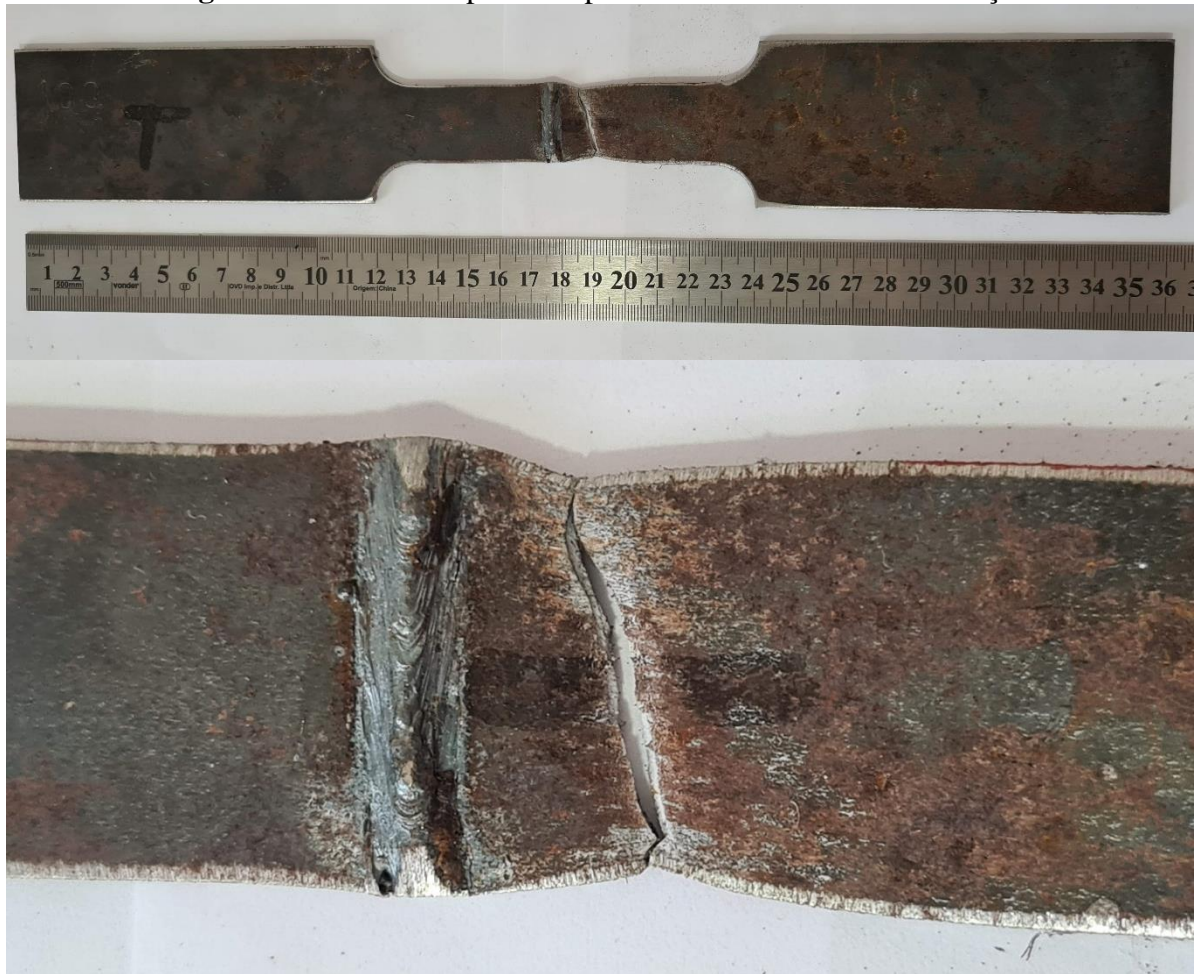
Figura 38 – CP1 CO2 puro rompido e detalhe da zona de estrição
