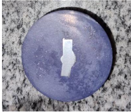
Figura 28 – Amostra após lixamento com lixa 400
