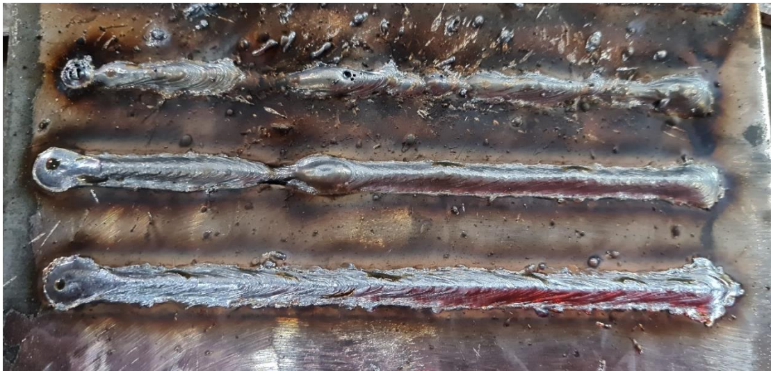
Figura 22 – Testes para diferentes configurações de DBCP e tensão utilizando CO 2 puro
