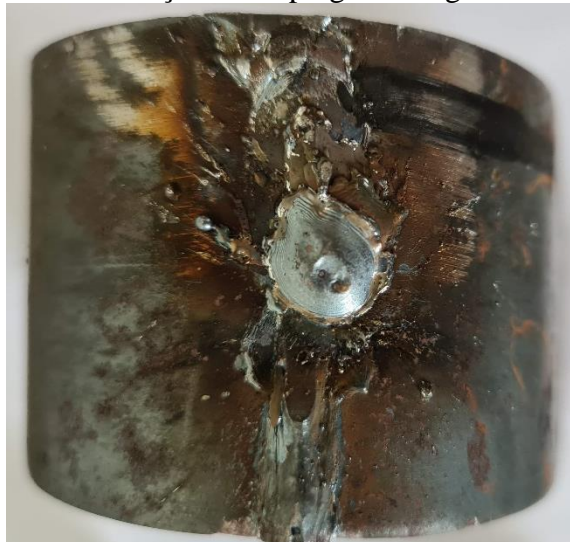
Figura 33 – Aumento da formação de respingos na região onde houve ponteamto
