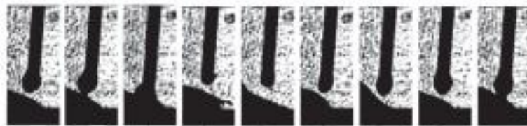
Figura 5 – Formação e transferência da gota metálica por curto circuito
