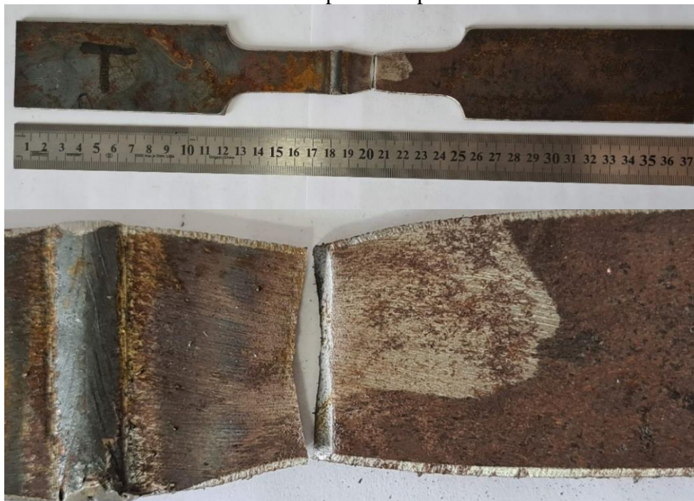
Figura 36 – CP2 mistura Ar + 25% CO2 após o rompimento e detalhe da zona de estrição
