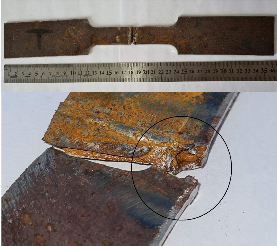
Figura 34 – CP1 mistura Ar + 25% CO 2 rompido e região onde havia um defeito na solda
