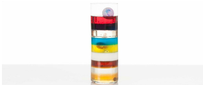
Figura 9 – Torre de Líquidos - Experimento de Densidade
