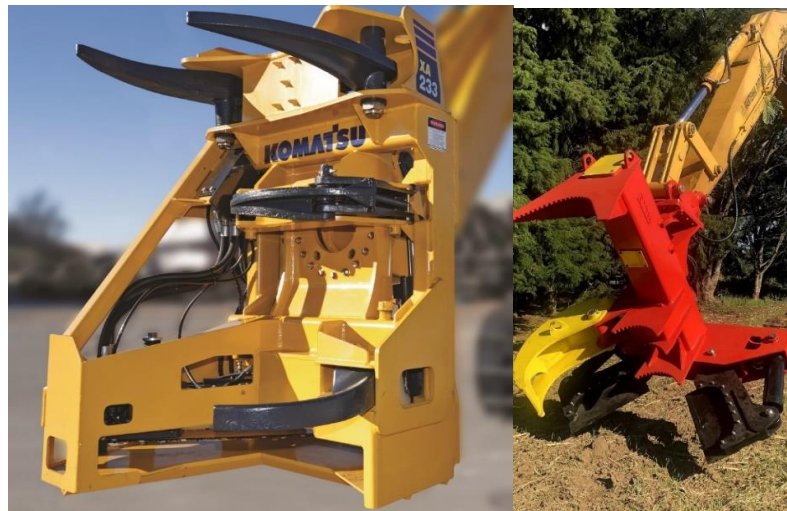
Figura 1 - Tipos de cabeçote feller: [1] modelo XA233 Komatsu (serra a disco) e [2] modelo CFT 50 RODER (tesoura)
