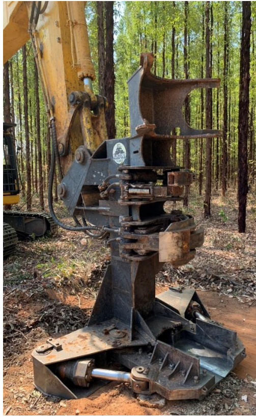
Figura 4 - Representação do cabeçote feller em estudo
