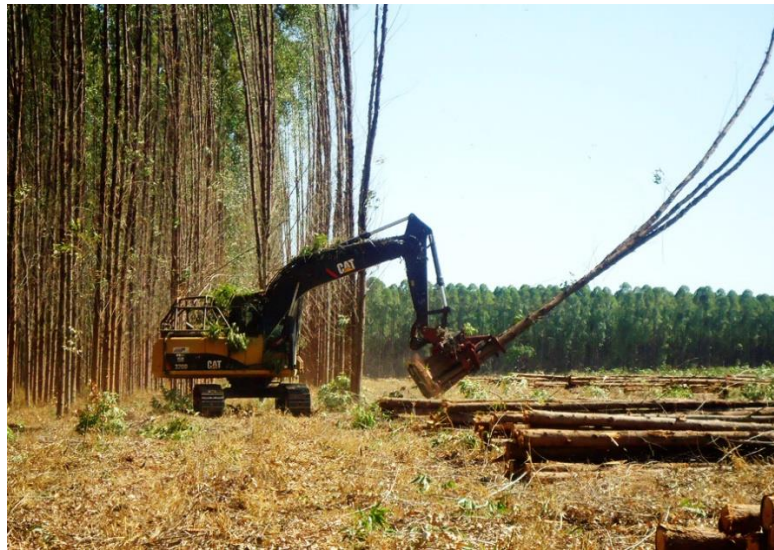
Figura 3 - Ciclo de extração do eucalipto - enleiramento dos troncos
