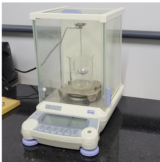
Figura 16: Densímetro acoplado à balança analítica. Multifunctional Quantum Materials Group, Instituto de Física - UFG
