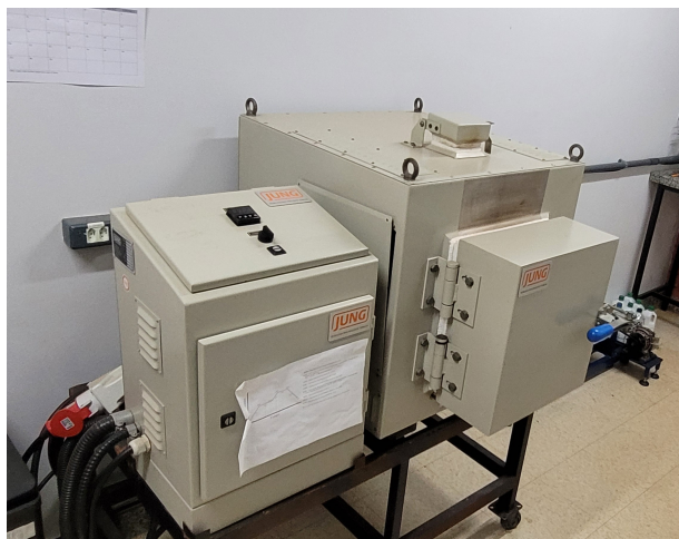
Figura 11: Forno mufla utilizado. Marca: Jung, modelo: LF0614. Instituto de Física - UFG
