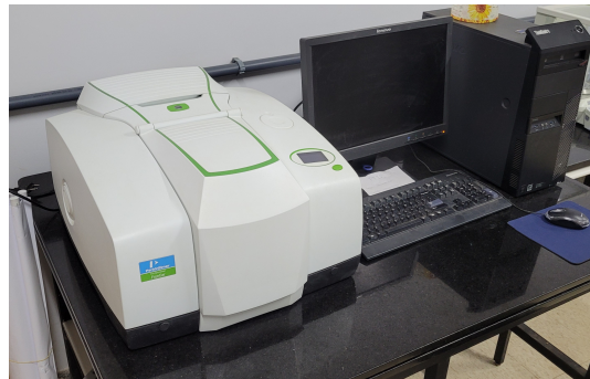
Figura 21: Espectrofotômetro de infravermelho com Transformada de Fourier. Multifuncional Quantum Materials Group, Instituto de Física - UFG
