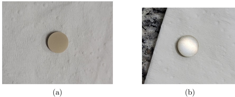
Figura 23: Comparação da pastilha antes e depois da lixagem.(a) Pastilha antes de ser lixada; (b) Pastilha após a lixagem.
