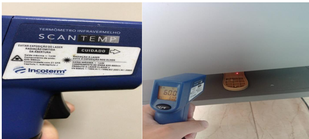
Figura 25-Medição de temperatura com uso de um termômetro infravermelho
