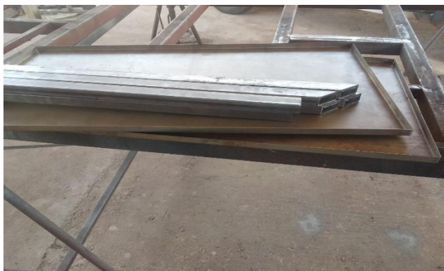
Figura 19- Corte dos tubos retangulares
