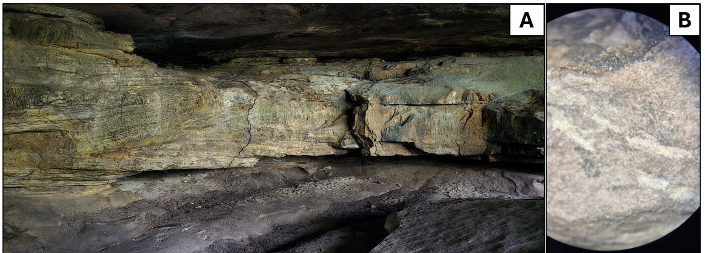
Figura 8.A-Afloramento do arenito (ponto_A01_14) onde é possível observar sets com baixo ângulo de mergulho com estratificações cruzadas planares e algumas concreções; B-Detalhe da amostra de arenito (ponto_A01_46) observada com a lupa de bancada (zoom de 13x). Notar a presença de feldspato (grãos esbranquiçados).
