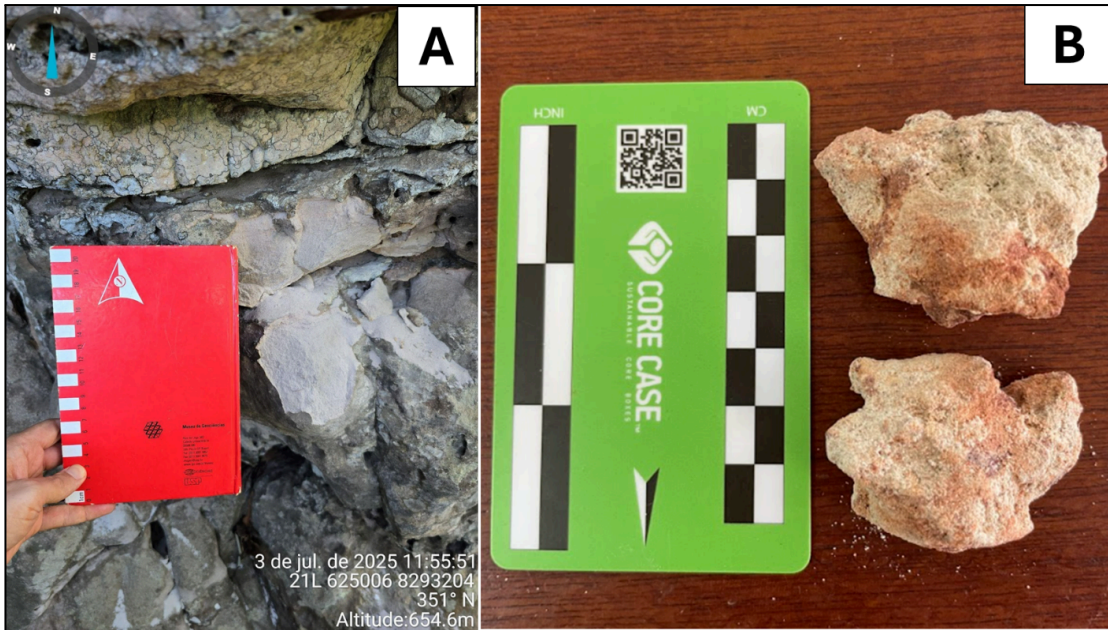
Figura 7. A- Afloramento de arenito muito fino com coloração esbranquiçada (ponto_A01_21), notar o acamamento; B- Amostra de arenito médio (ponto_A01_15), notar aspecto mais friável e coloração marrom acobreada devido ao intemperismo.
