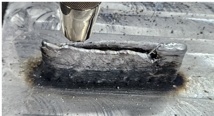
Figura 15 – Perfil fabricado na segunda tentativa para otimização de trajetória
