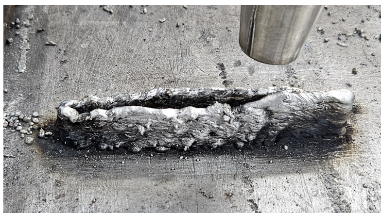
Figura 14 – Perfil fabricado na primeira tentativa para otimização de trajetória
