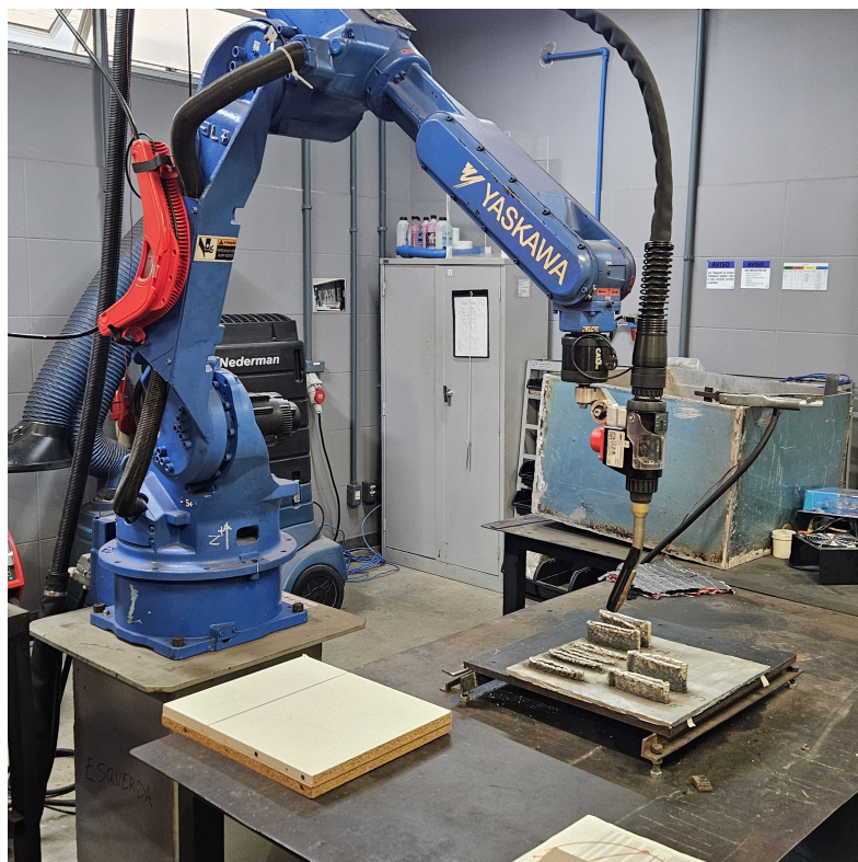
Figura 2 – Estação de trabalho com manipulador robótico Yaskawa Motoman HP20D
