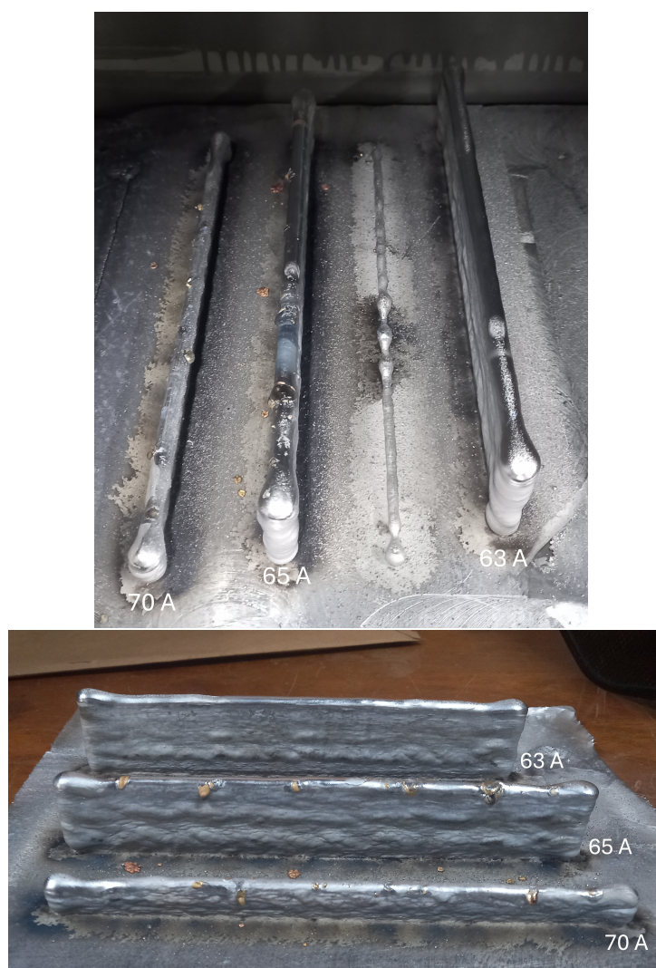
Figura 8 – Paredes fabricadas na primeira, segunda e terceira tentativa com arame 1,0 mm
