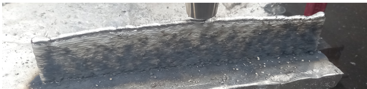
Figura 6 – Parede fabricada na segunda tentativa com arame 1,2 mm em modo curto-circuito
