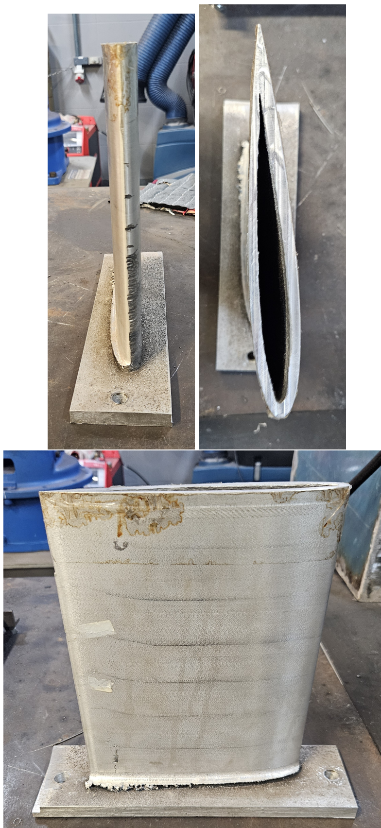
Figura 18 – Modelo final de aerofólio fabricado
