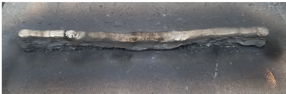
Figura 10 – Parede fabricada com configuração 64 A a-70 para arame 0,8 mm
