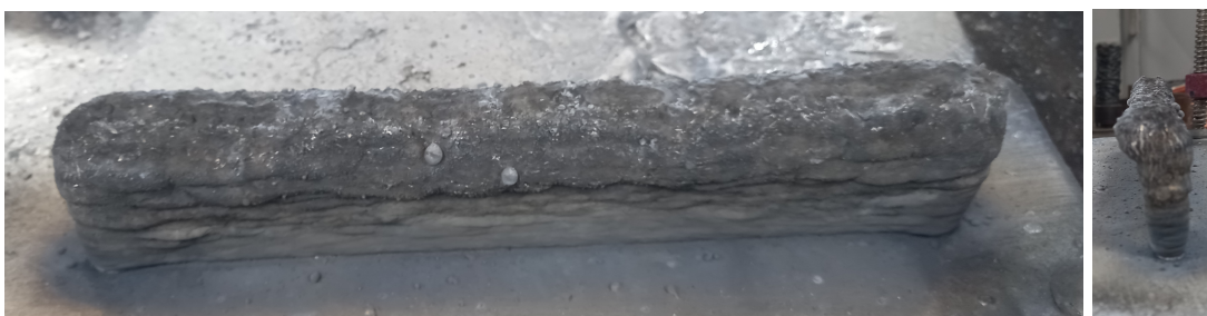
Figura 5 – Parede fabricada na primeira tentativa com arame 1,2 mm em modo curto-circuito
