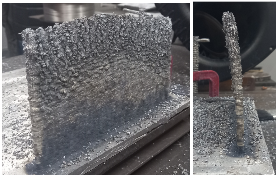
Figura 7 – Parede fabricada na terceira tentativa com arame 1,2 mm em modo curto-circuito
