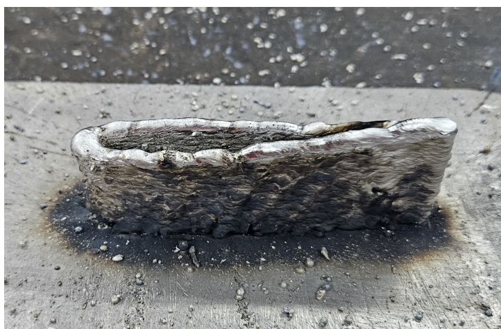
Figura 16 – Perfil fabricado na terceira tentativa para otimização de trajetória
