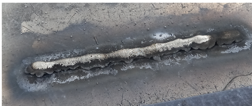
Figura 12 – Parede fabricada em modo pulsado convencional para arame 0,8 mm
