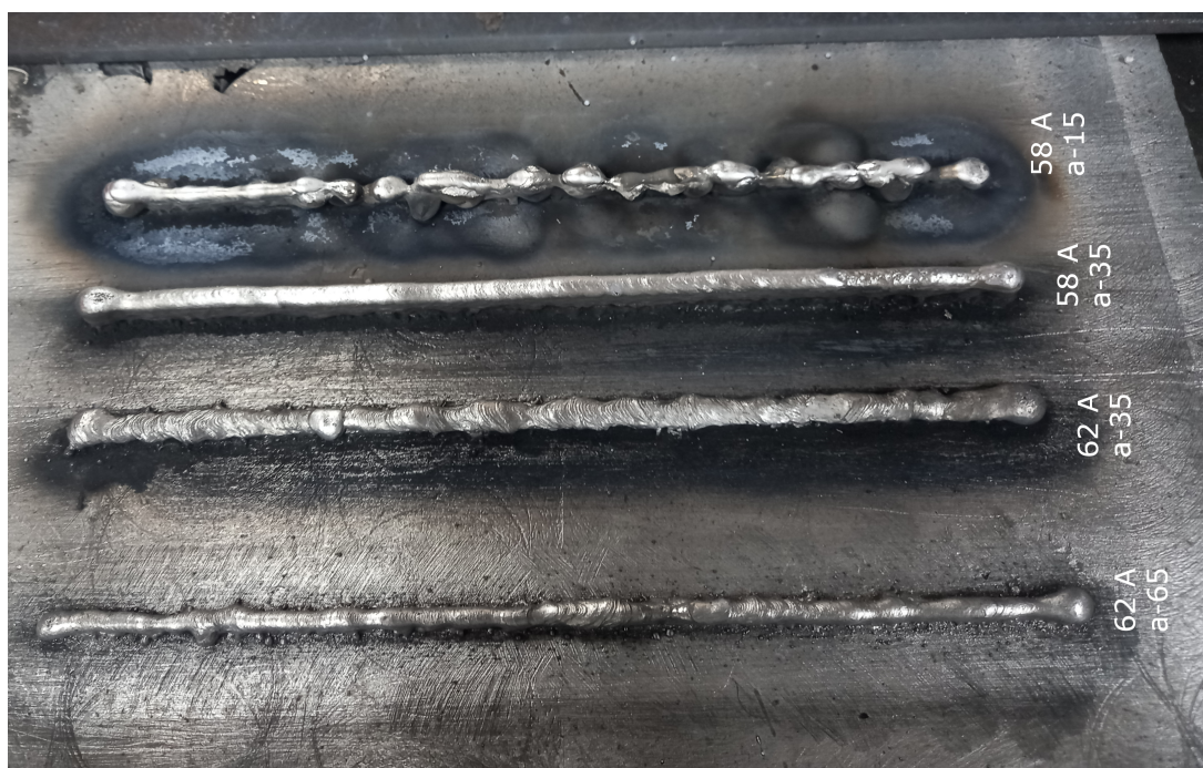
Figura 11 – Paredes fabricadas com diferentes configurações para arame 0,8 mm
