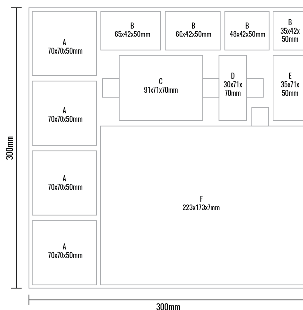
Figura 25 - Dimensões e leiaute do insert .
