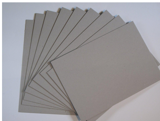
Figura 17 - Exemplo de grey board 2mm.
