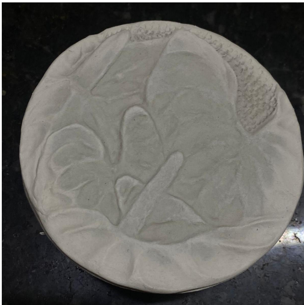
Figura 50 – Teste preliminar em cerâmica fria durante o processo de secagem, evidenciando maior perda de umidade nas extremidades.
