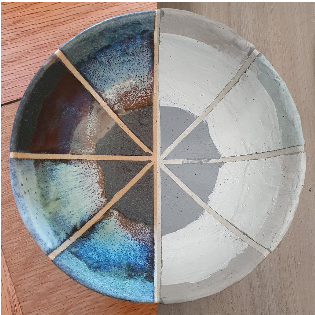
Figura 10 – Exemplo de produto cerâmico com diferentes resultados de esmaltação antes e após a queima.
