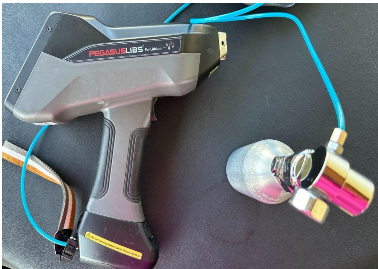
Figura 2.1: Analisador portátil PEGASUSLIBS (modelo P-3Li) com cilindro de gás argônio, utilizado para análise do teor de lítio.
