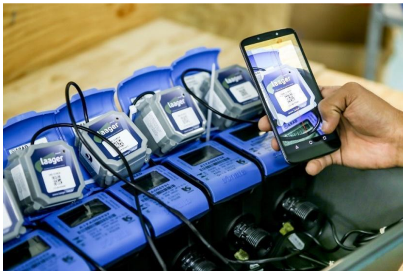
Figura 1 - Medidores inteligentes de consumo de água baseados em IoT – SMART Modular Technologies
