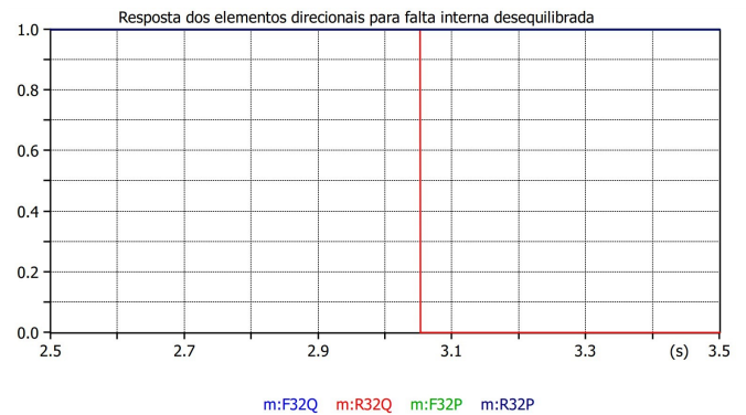
Figura 21. Resposta da função direcional para faltas desequilibradas internas
