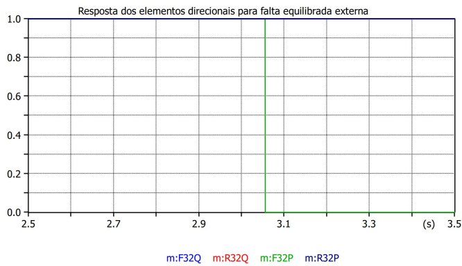
Figura 18. Resposta da função direcional para faltas equilibradas à frente
