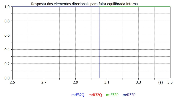
Figura 20. Resposta da função direcional para faltas equilibradas internas
