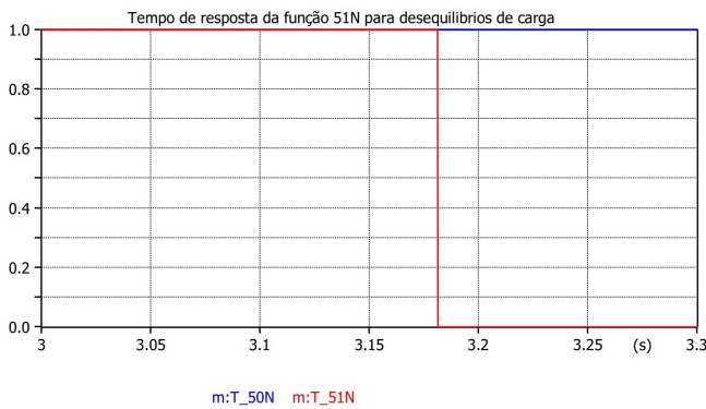
Figura 26. Resposta da função direcional para faltas desequilibradas internas
