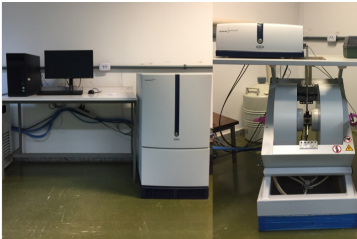
Figura [7] Fonte: própria autoria. Foto do espectrômetro de RPE do laboratório de biofísica (Instituto de Física – UFG).
