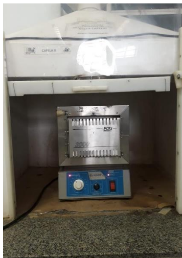
Figura 10: Amostra sendo incinerada em mufla.
