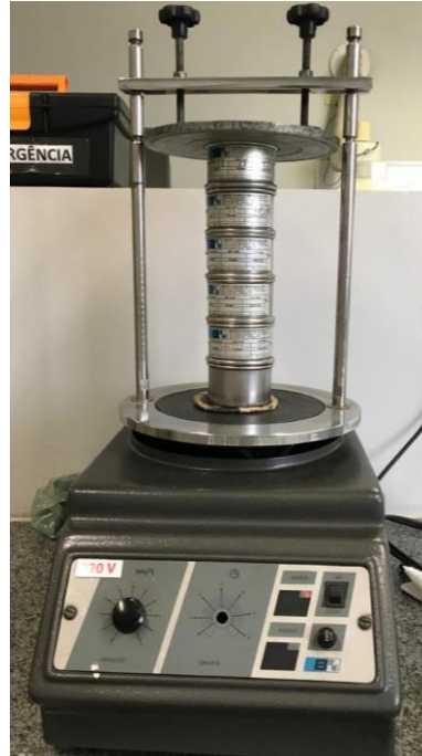
Figura 7: Amostra em agitador eletromagnético de peneiras.
