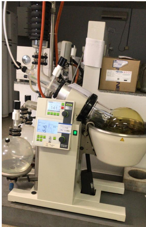
Figura 15: Extrato de Camellia sinensis em rotaevaporador.
