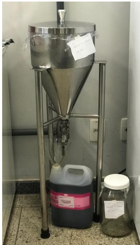
Figura 13: Extrato sendo produzido em percolador.
