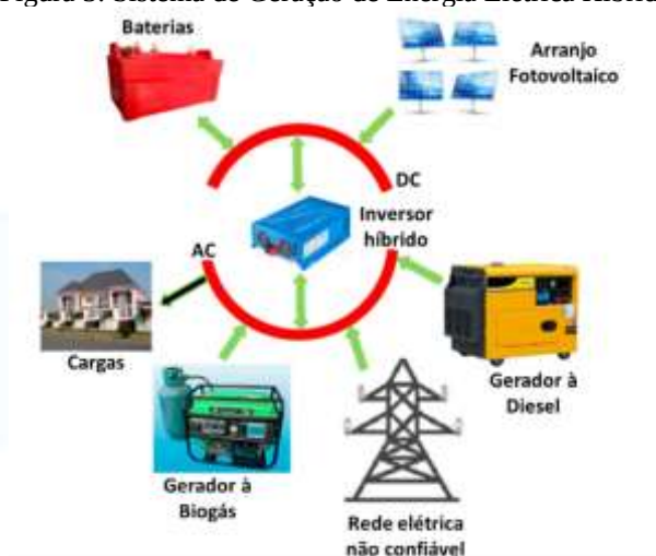
Figura 3: Sistema de Geração de Energia Elétrica Híbrido.
