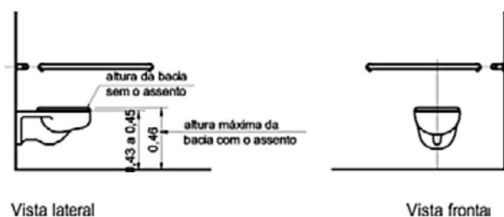
Figura: 1.5: Bacias sanitárias
