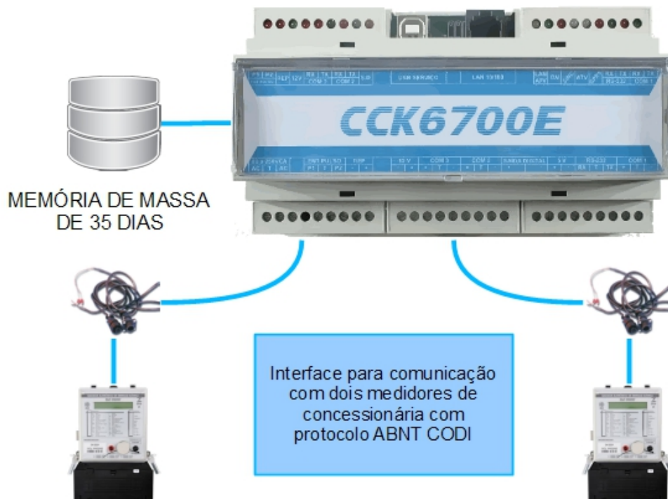
Figura 2 – Esquema Conexões Medição de Fronteira
