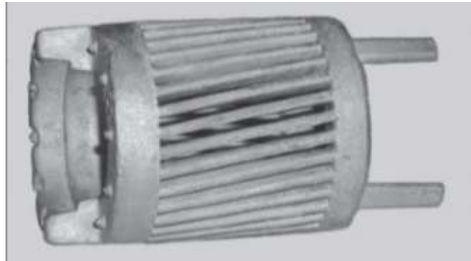
Figura 4 – A estrutura da gaiola de esquilo depois que as lâminas do rotor foram submetidas à corrosão
