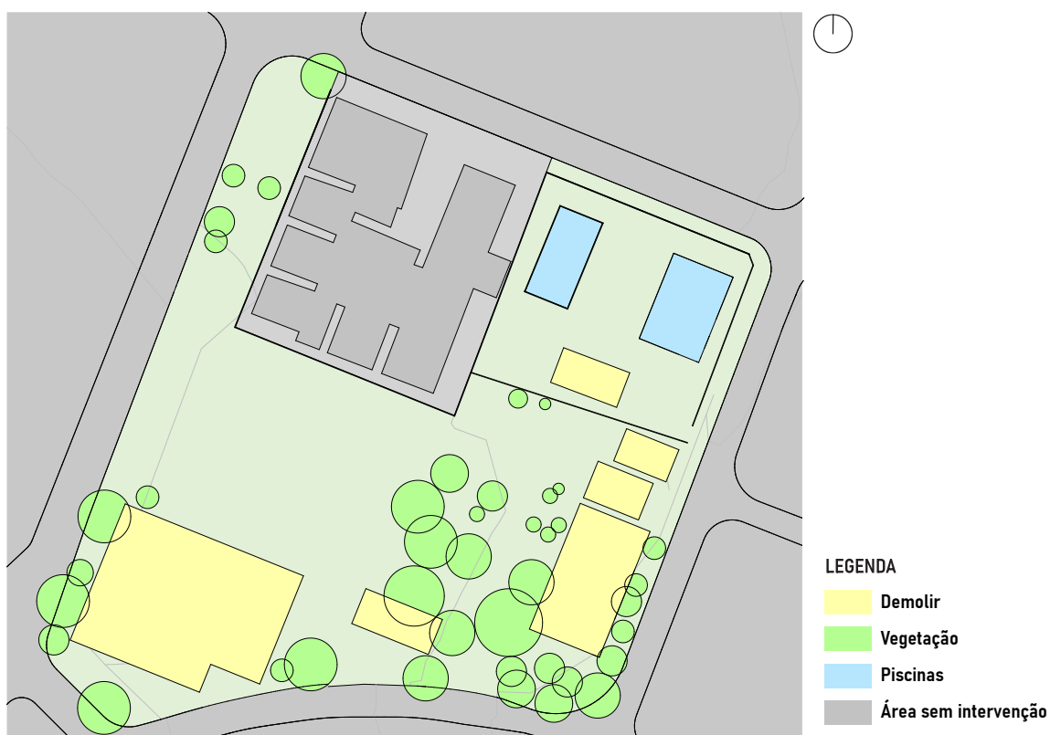
Figura 47: Planta de demolir. Fonte: Elaborado pela autora, 2025.
