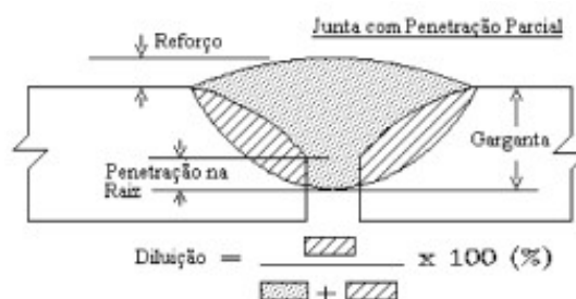
Figura 7 – Geometria e diluição em uma junta a topo com penetração parcial.
