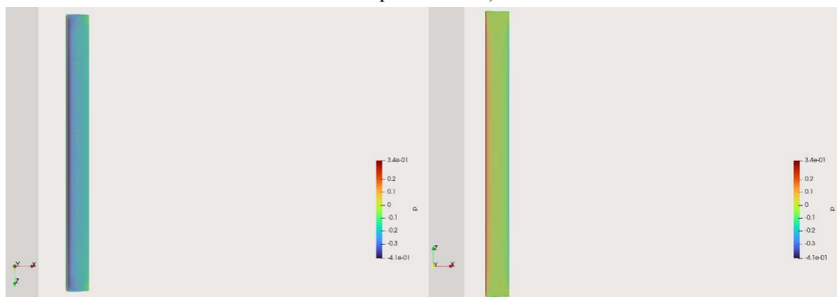
Figura 5.12. Distribuição de pressão sobre a asa para RA = 12,0 (vista superior e inferior, respectivamente)
