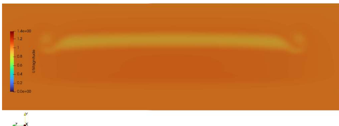
Figura 5.14. Campo de velocidade na saída do escoamento para RA=12,0
