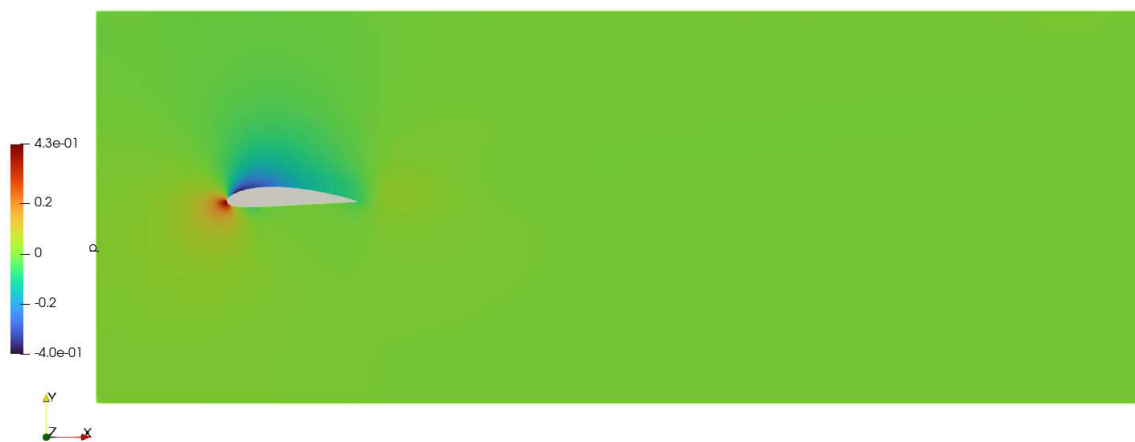
Figura 5.9. Campo de pressão em um plano localizado no centro de asa
