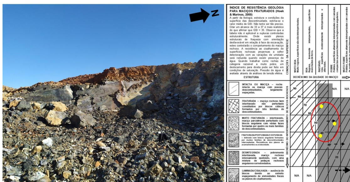
Figura 34: Afloramento de dunito parcialmente serpentinizado e, ao lado, plotagem dos valores atribuídos para o GSI (Ponto 6).
