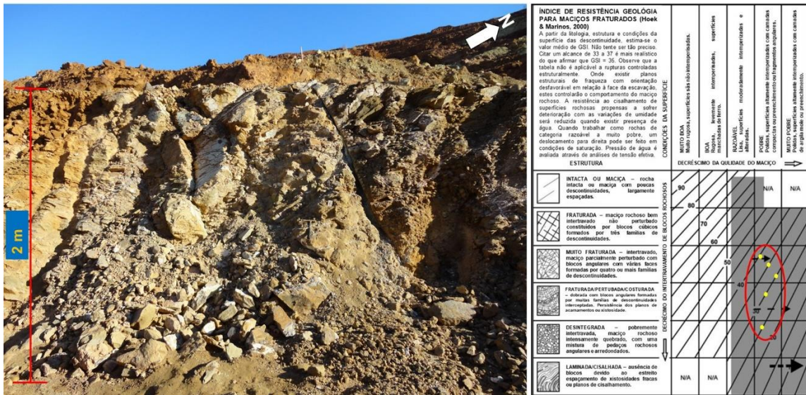
Figura 36: Afloramento de boulder e, ao lado, plotagem dos valores atribuídos para o GSI (Ponto 195).
