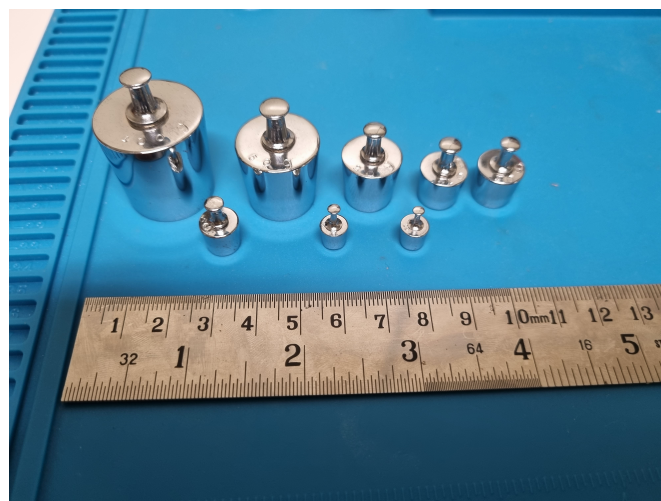
Figura 4.6: Conjunto de pesos padrões de 100, 50, 20, 10, 5, 2 e 2 gramas adotados para fins de calibração.
