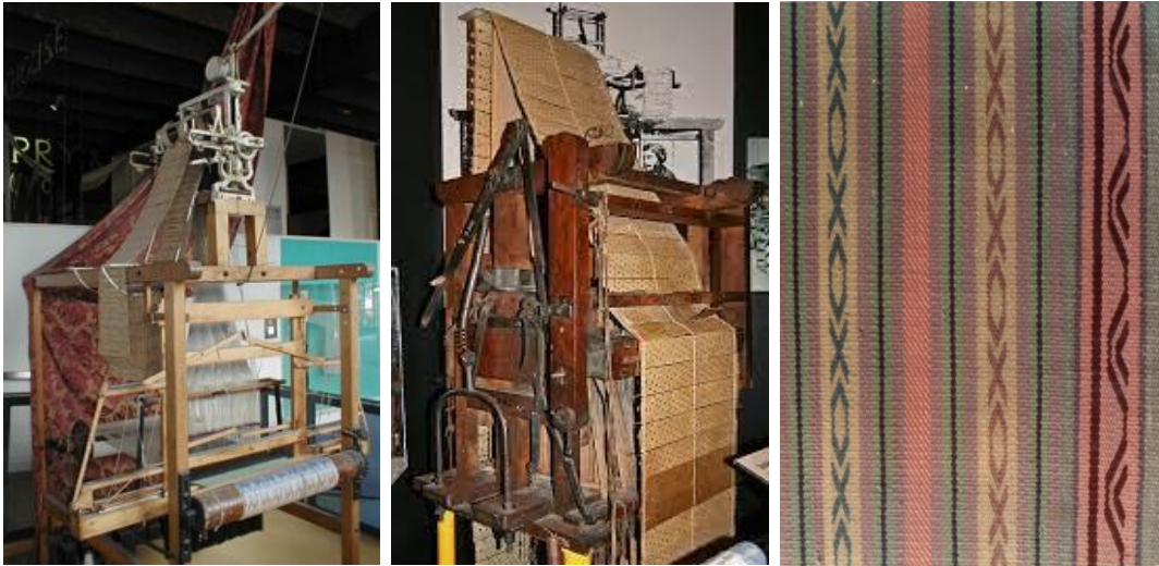
Figura 16 - Tecido Jacquard sendo produzido pelo sistema de cartões
