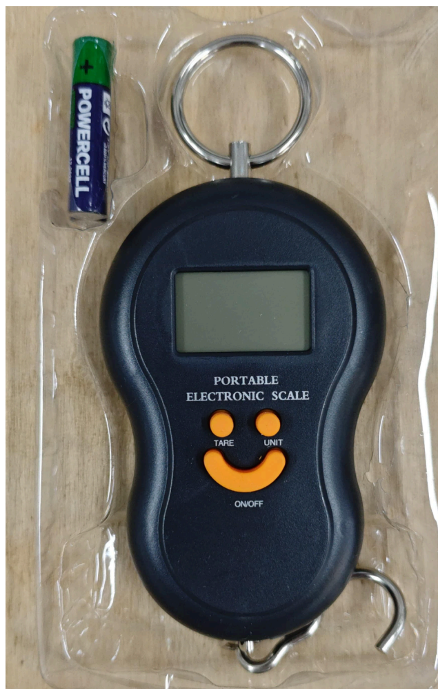
Figura C.2: Balança de peixe proposta para utilização como dinamômetro no ensaio de tração
