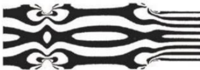
Figura 2.7: Análise fotoelástica da barra plana
