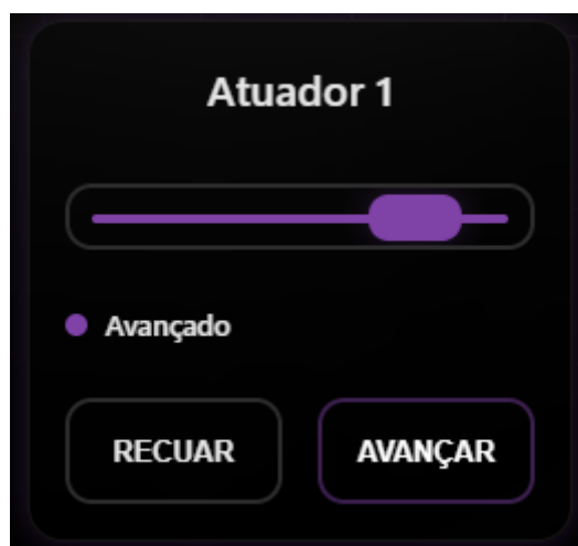
Figura 23 – Representação do atuador estendido no servidor web
