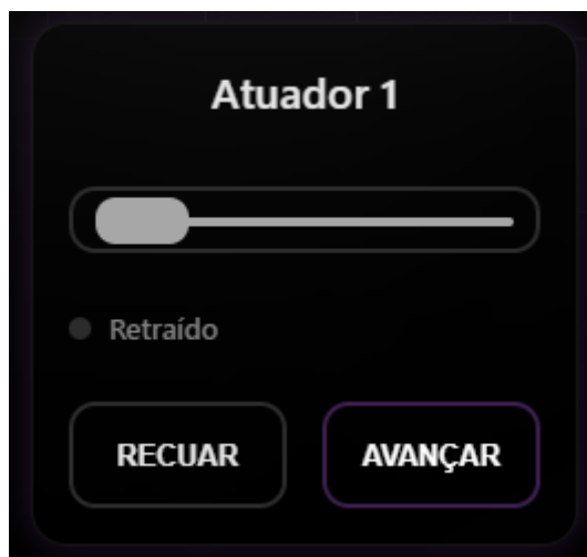
Figura 22 – Representação do atuador retraído no servidor web
