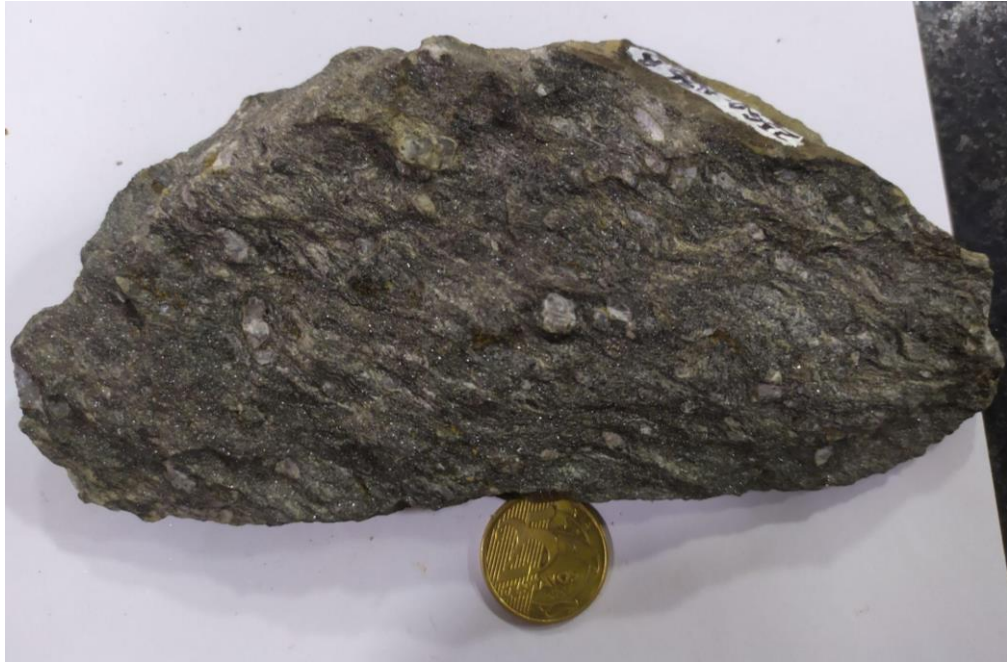
Figura 17 - Amostra de mão do ponto 23GO_036, onde nota-se uma foliação milonítica com presença de porfiroclastos de plagioclásio e quartzo.
