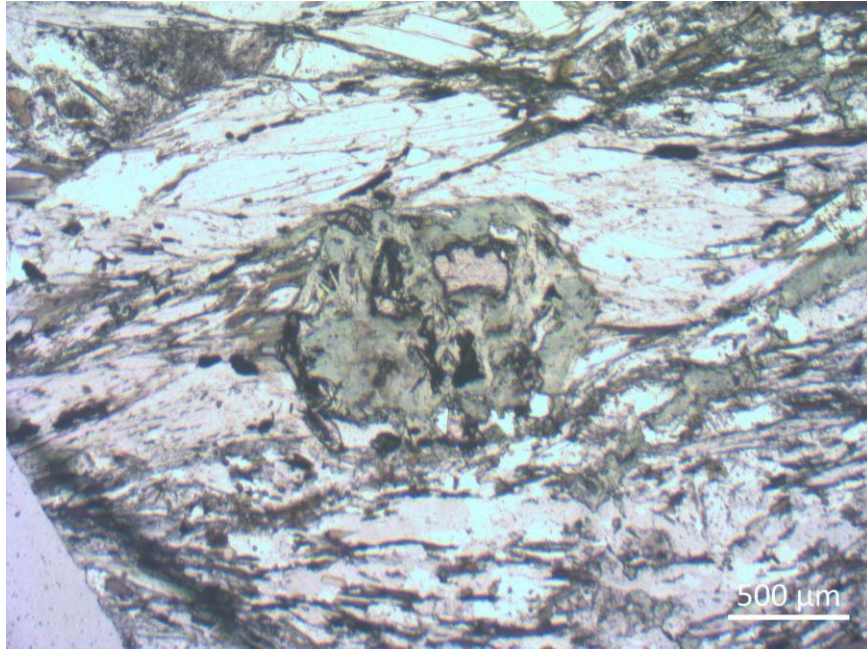
Figura 34 - Fotomicrografia de porfiroblasto de granada quase que totalmente substituído por clorita, durante o retrometamorfismo. Lâmina 23GO_22-P1, aumento de 25 vezes, nicóis descruzados.
