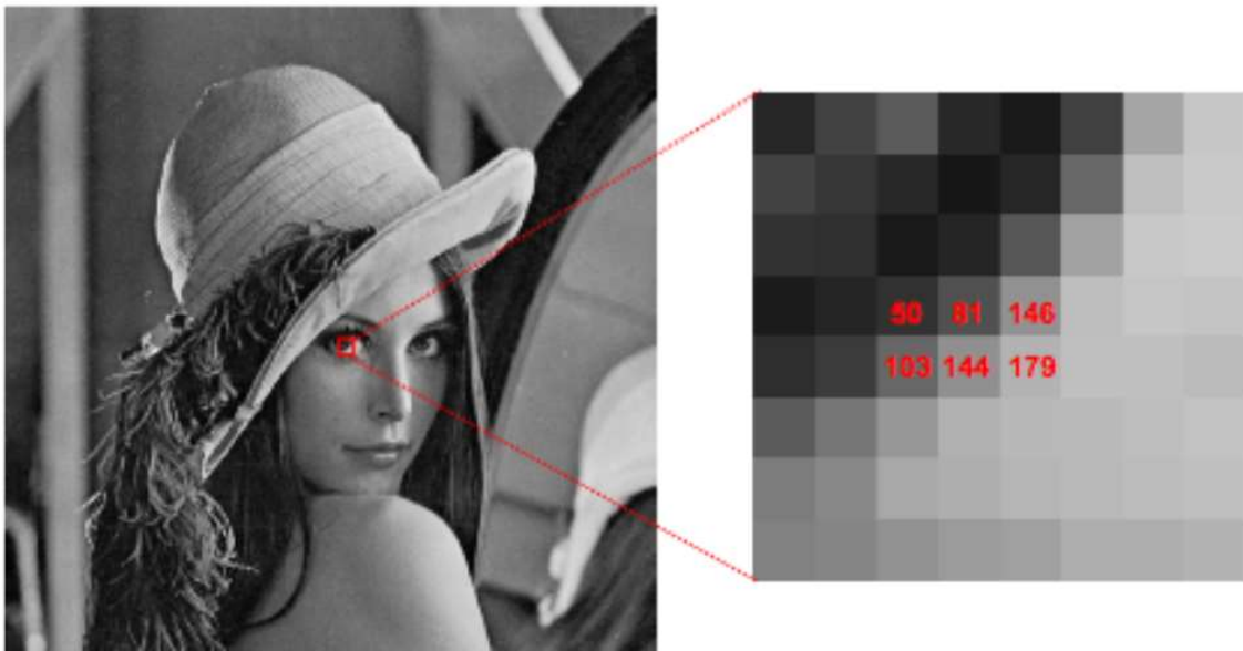
Figura 18 - Observação do detalhamento de uma imagem e sua composição por pixels com intensidade de cores diferentes (Autoria da imagem [5])
