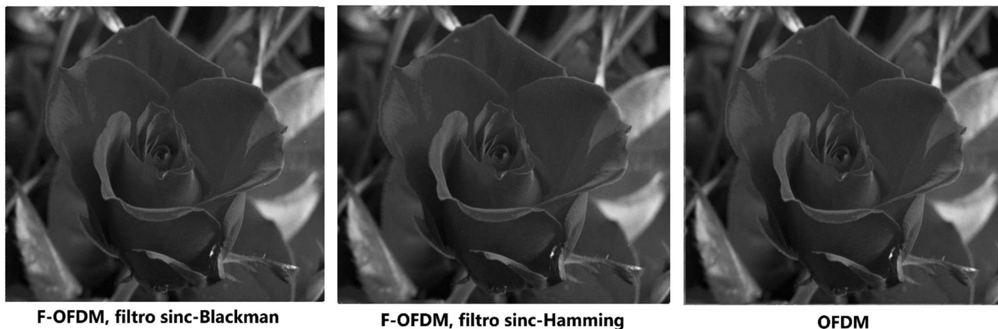
Figura 39 – Imagens recebidas após a redução do número de bits por símbolo da modulação 16-QAM para QPSK
