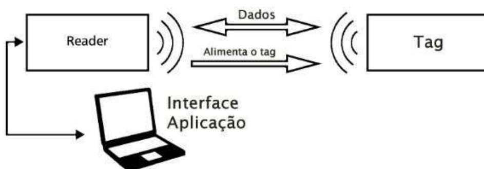
Figura 03 – Diagrama de funcionamento de um sistema RFID
