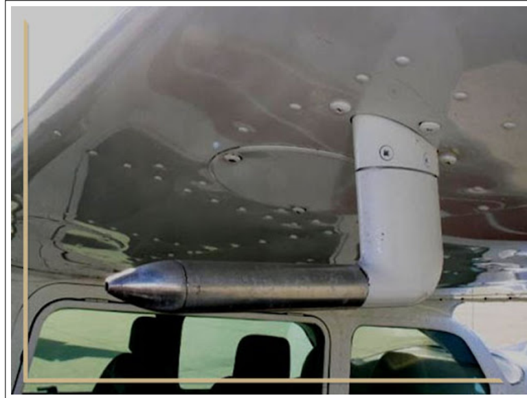
Figura 3 – Posicionamento do tubo de Pitot em uma Aeronave.
