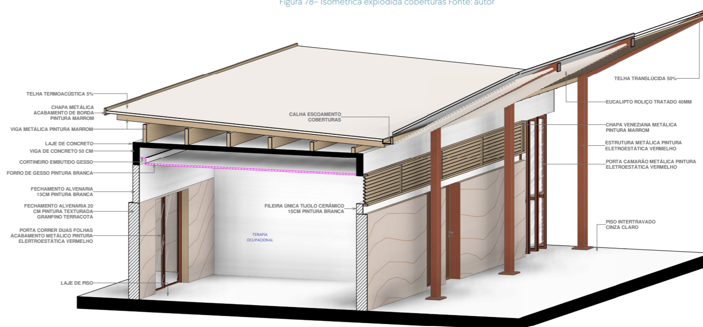
Figura 79- Isométrica estrutura bloco unidade terapêutica Fonte: autor
