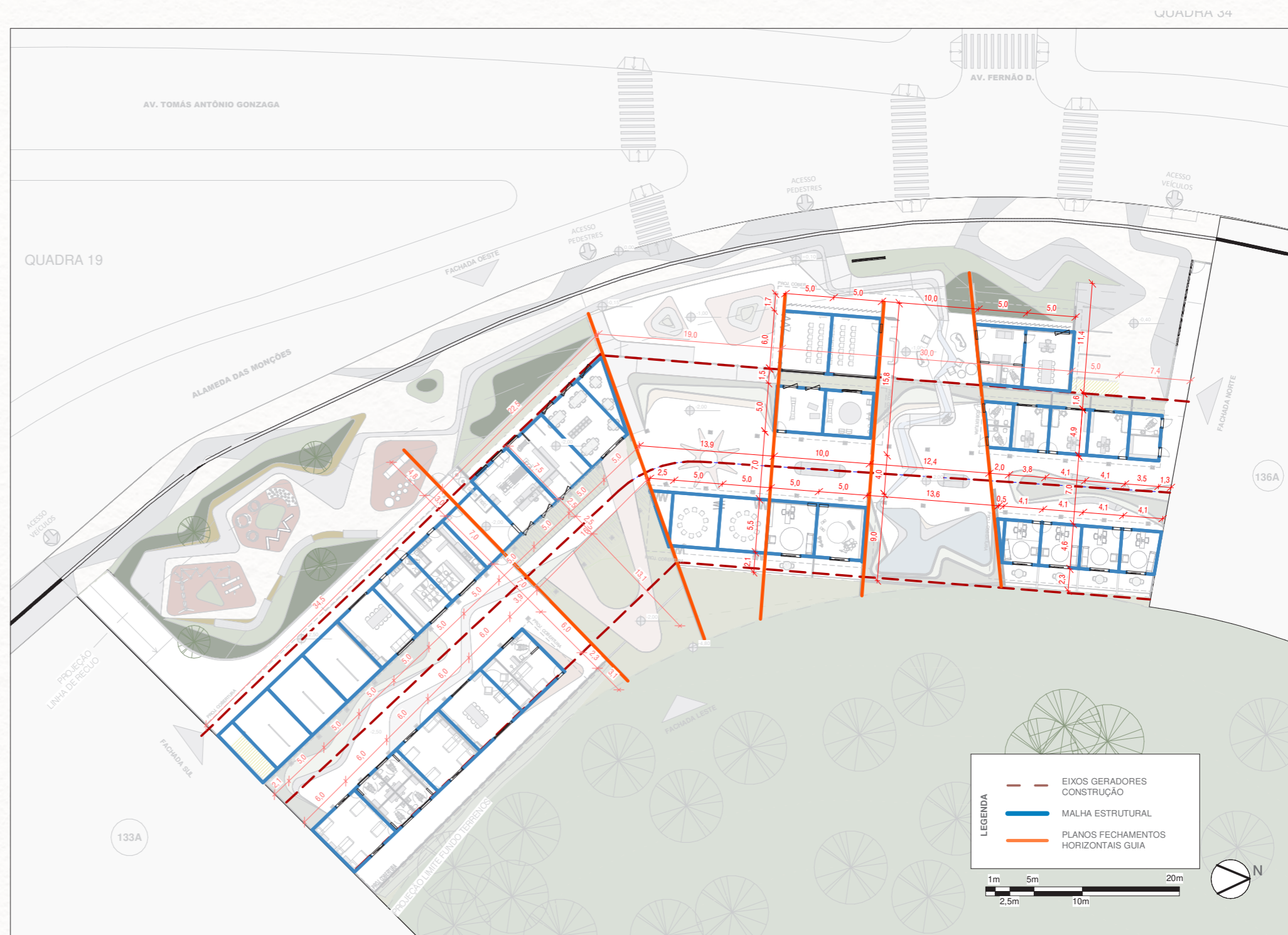
Figura 77- Planta estrutural e planos Fonte: autor
