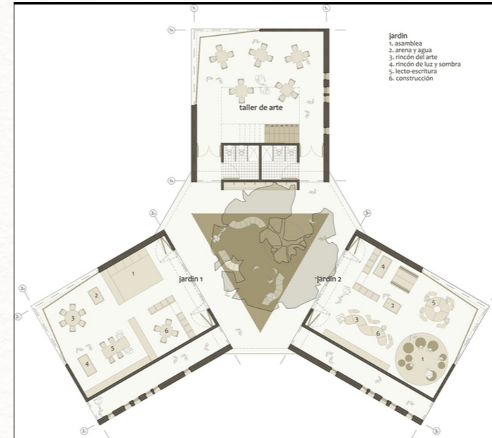
Figura 62 e 63- Da esquerda para a direita: Planta baixa dos polos com divisões internas a partir do mobiliário e vista interna de um dos polos. Fonte: www.archdaily.com.br/
