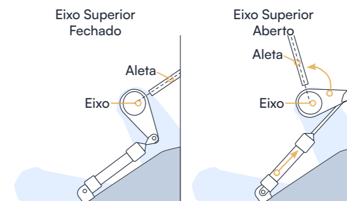
Figura 45: Diagrama de funcionamento das haletas Fonte: Fruto a beira mar, Globo. Modificado pelo autor
