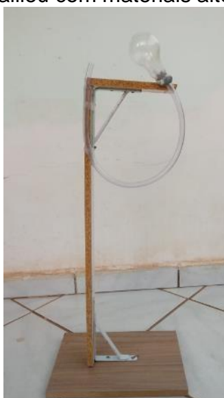
Figura 4 - Termoscópio de Galileu com materiais alternativos.
