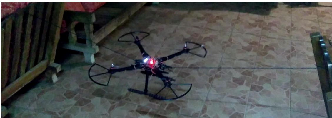
Figura 47 - Fixação do drone para realização de testes e calibrações
