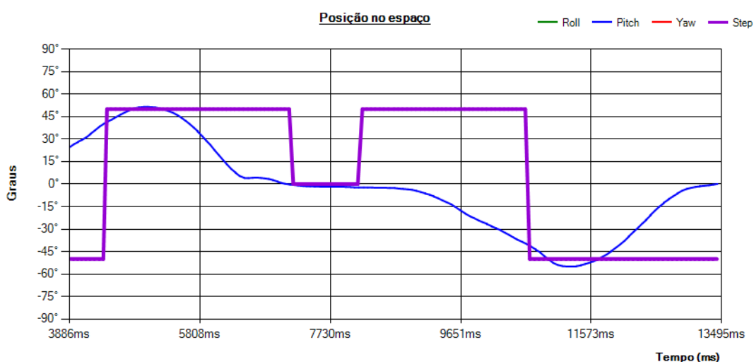
Figura 51 - Resposta ao degrau do drone com controlador PID angular
