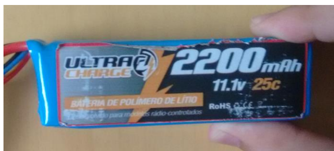
Figura 1 - Bateria utilizada como fonte principal de energia
