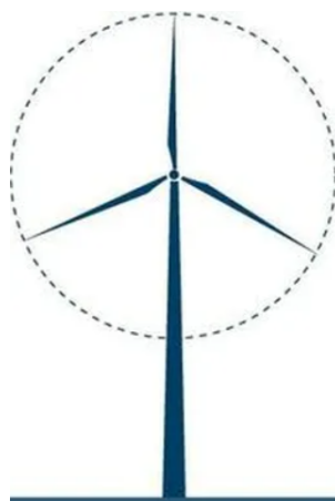
Figura 14 - Área de passagem do escoamento por uma turbina eólica de área circular 3 .
