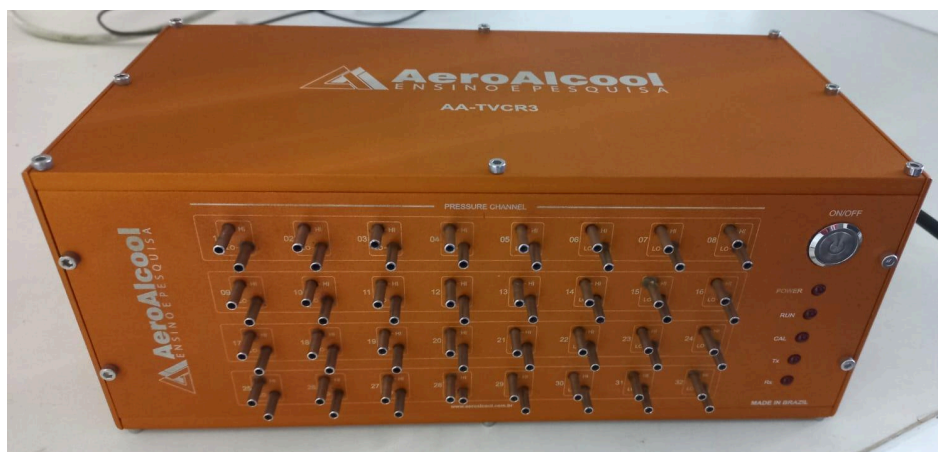
Figura 20 - Manômetro AeroAlcool, Módulo de Pressão 32x AA-TVCR3.
