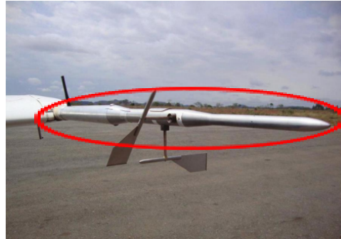
Figura 8 - Tubo de Pitot como medidor de velocidade na asa de uma aeronave.
