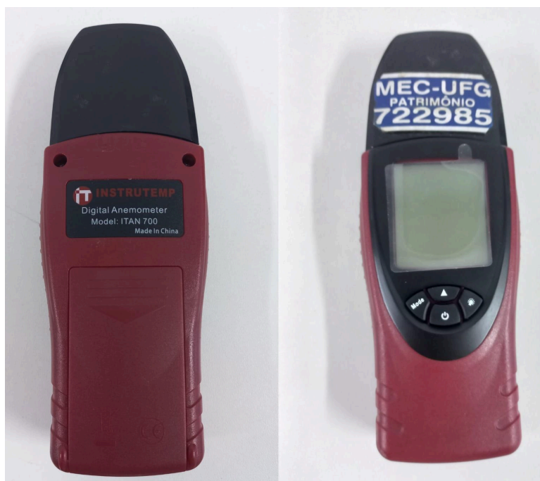
Figura 22 - Anemômetro Digital ITAN 700 INSTRUTEMP.
