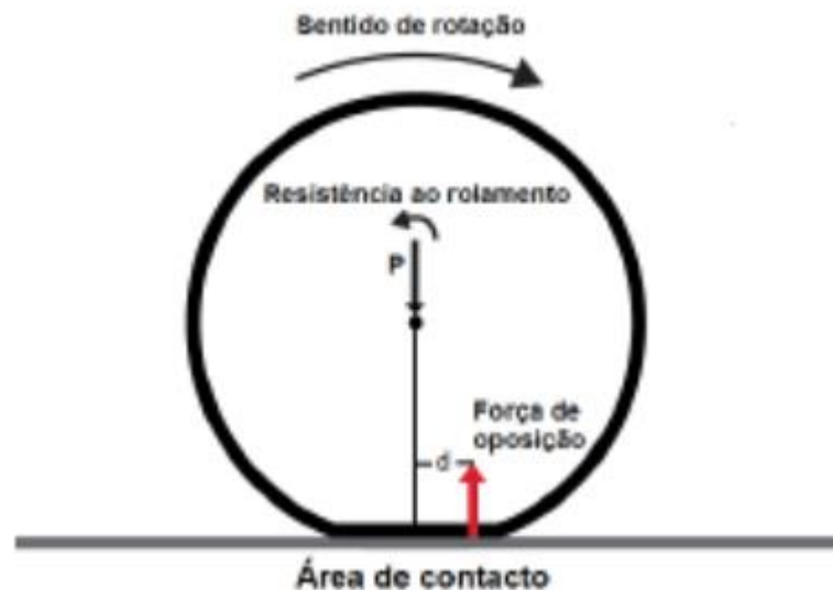
Figura 2. Deformação de pneu devido aplicação de carga
