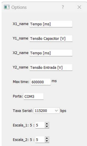
Figura 26: Configuração do software para leitura do circuito RC.
