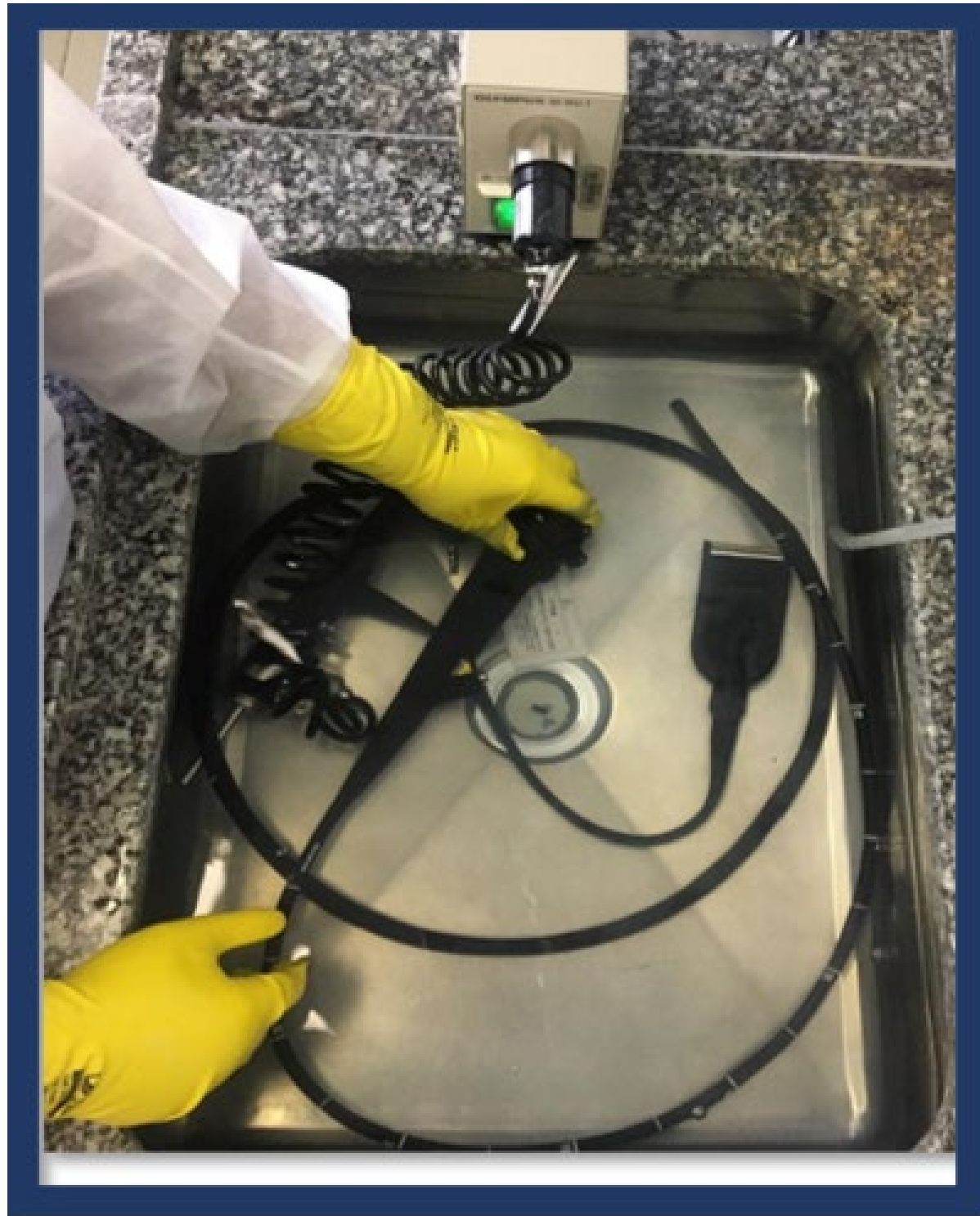
Figura 5 - Etapa 2: Teste de vedação/ vazamento
