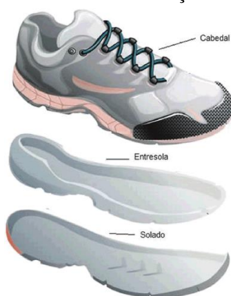
Figura 12: Estrutura do Calçado Esportivo.
