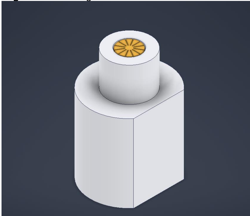
Figura 3.3 - Montagem da bucha com o microfone de ¼”
