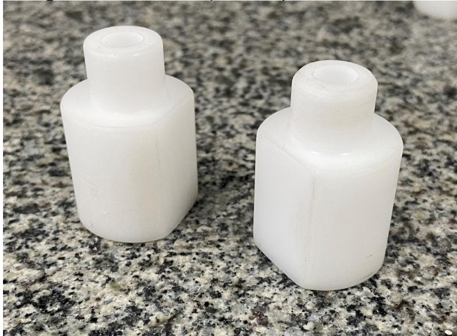
Figura 3.14 - Buchas de poliacetal para microfone de ¼"
