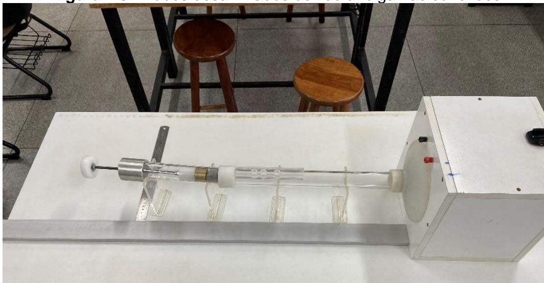
Figura 1.3 - Tubos desalinhados devido a folga nas conexões
