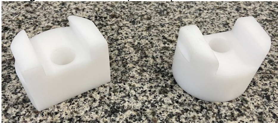
Figura 3.15 - Buchas de poliacetal para microfone de ½"
