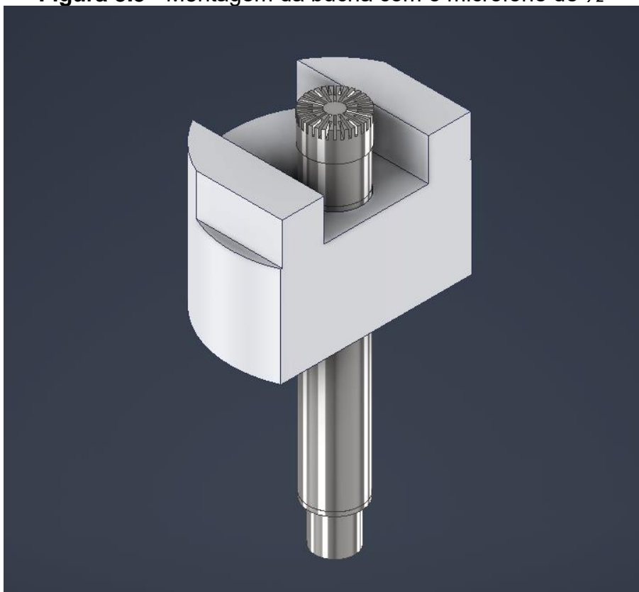
Figura 3.5 - Montagem da bucha com o microfone de 1/2”
