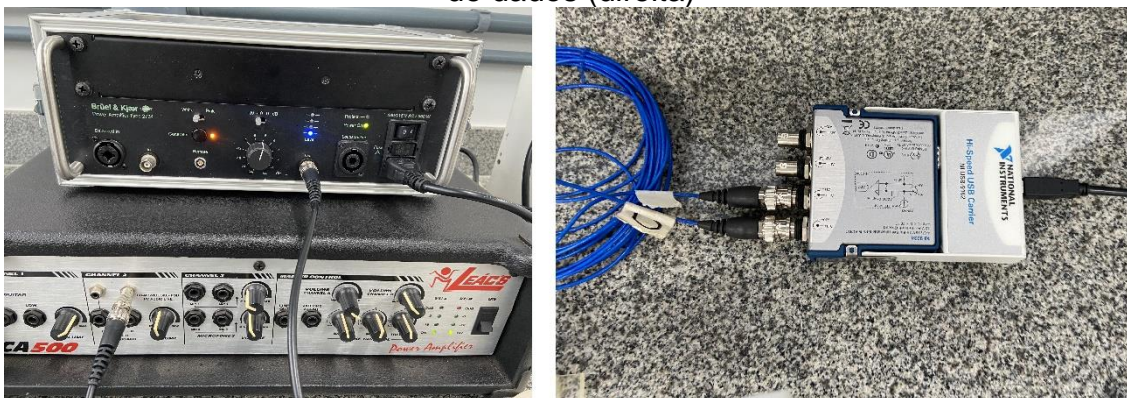
Figura 3.11 - Gerador de ruído e amplificador (esquerda) e placa de aquisição de dados (direita)
