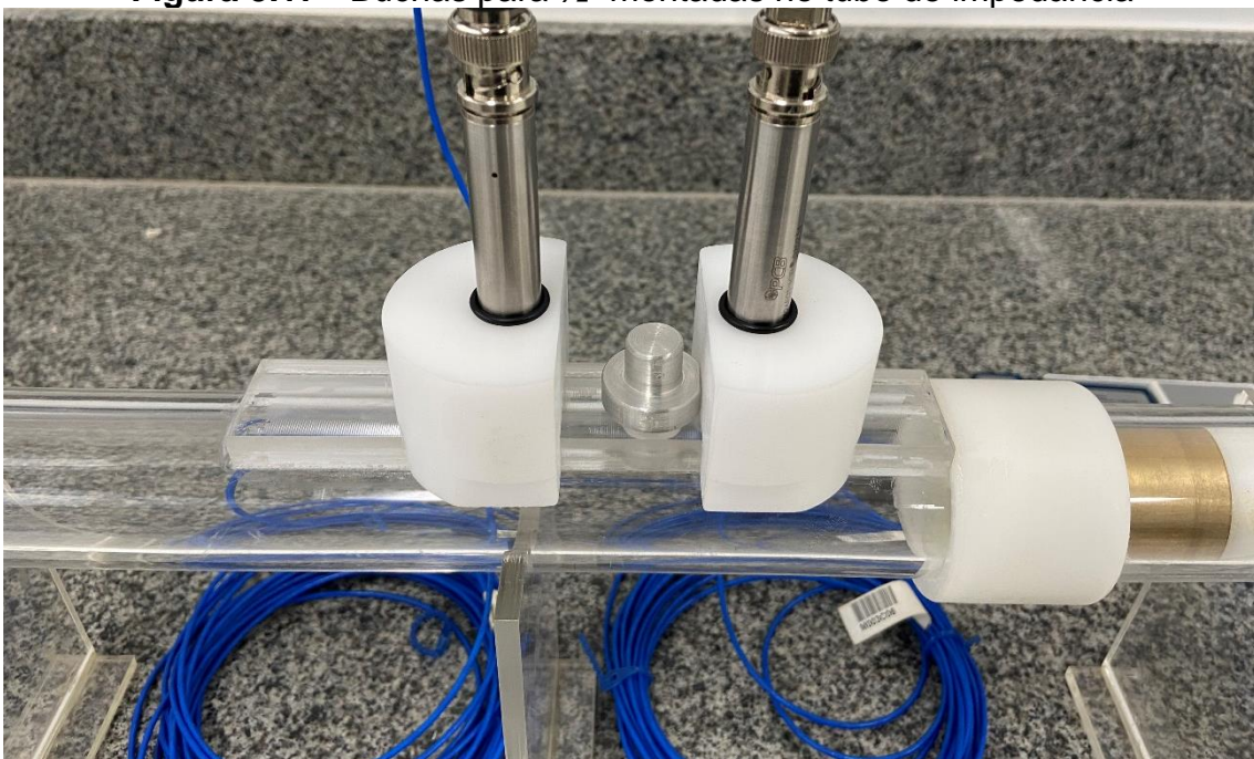
Figura 3.17 - Buchas para ½" montadas no tubo de impedância
